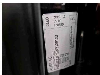
Fahrzeug - Typenschild/Fahrgestellnummer
