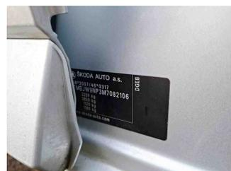
Fahrzeug - Typenschild/Fahrgestellnummer
