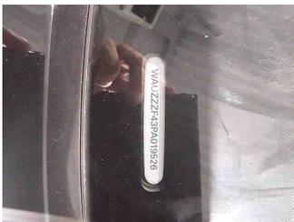
Fahrzeug - Typenschild/Fahrgestellnummer
