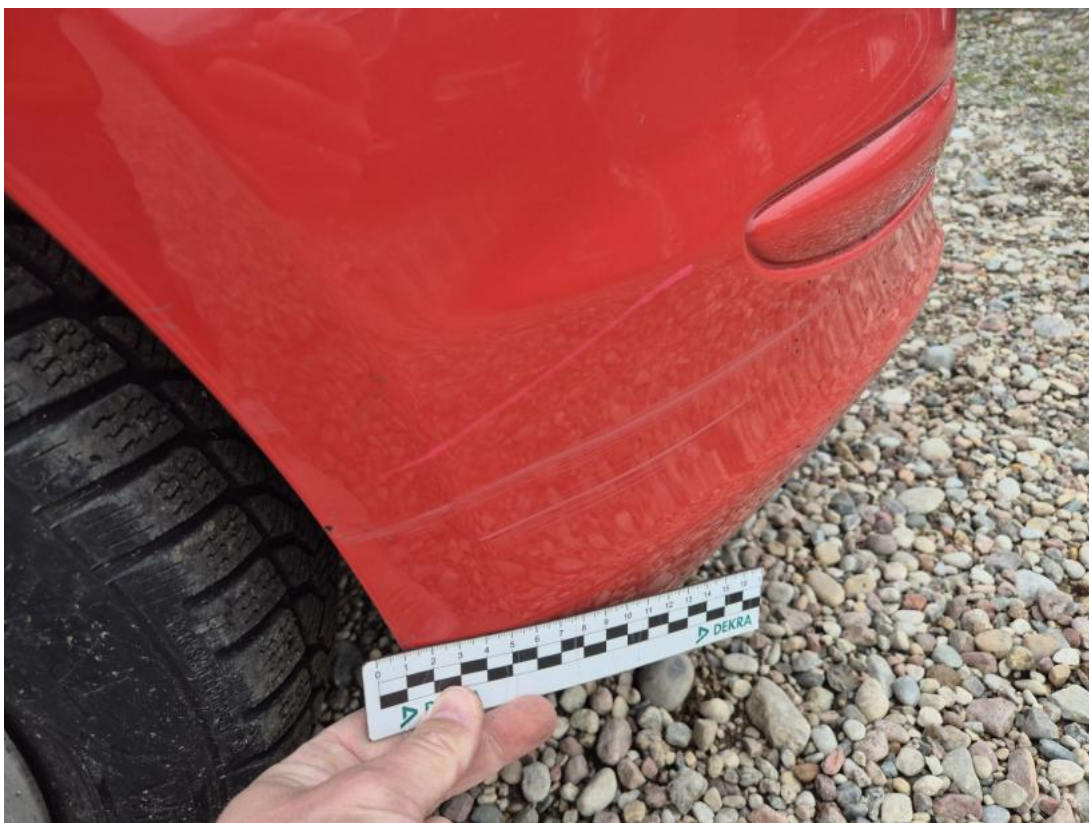
Fot. 33 Zderzak - Rysa/odprysk 2
