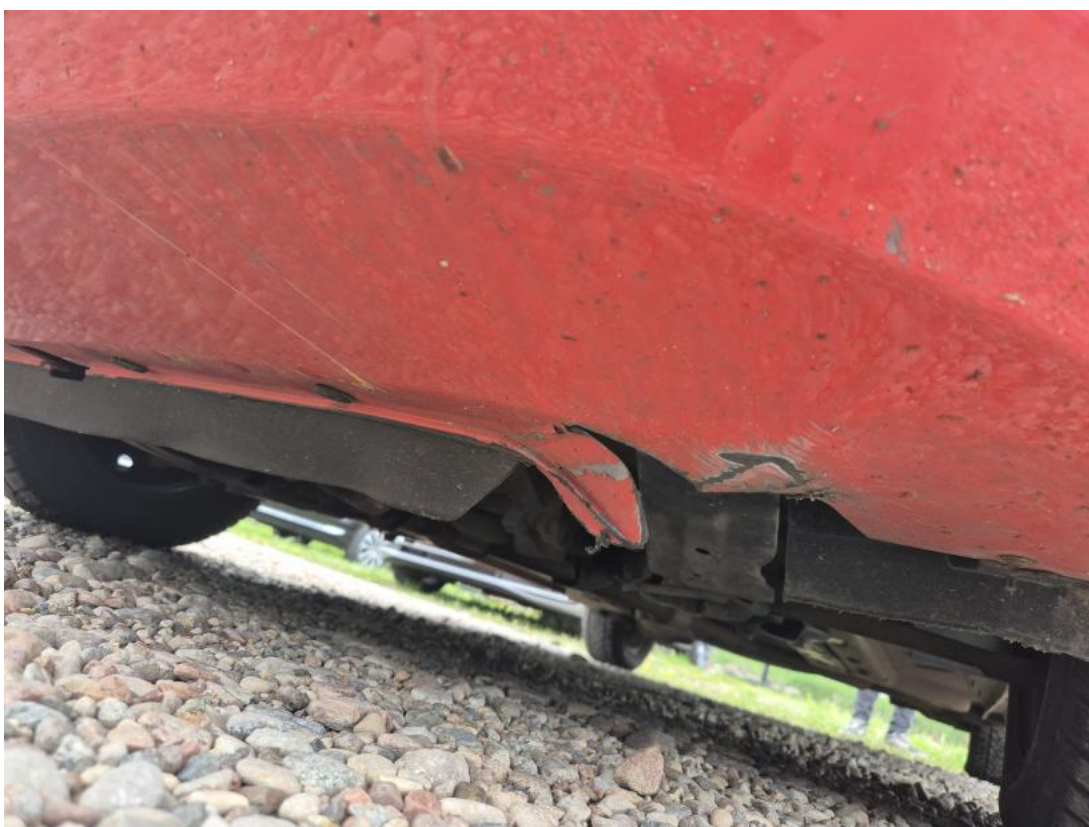
Fot. 34 Zderzak - Pęknięcie/rozerwanie 1
