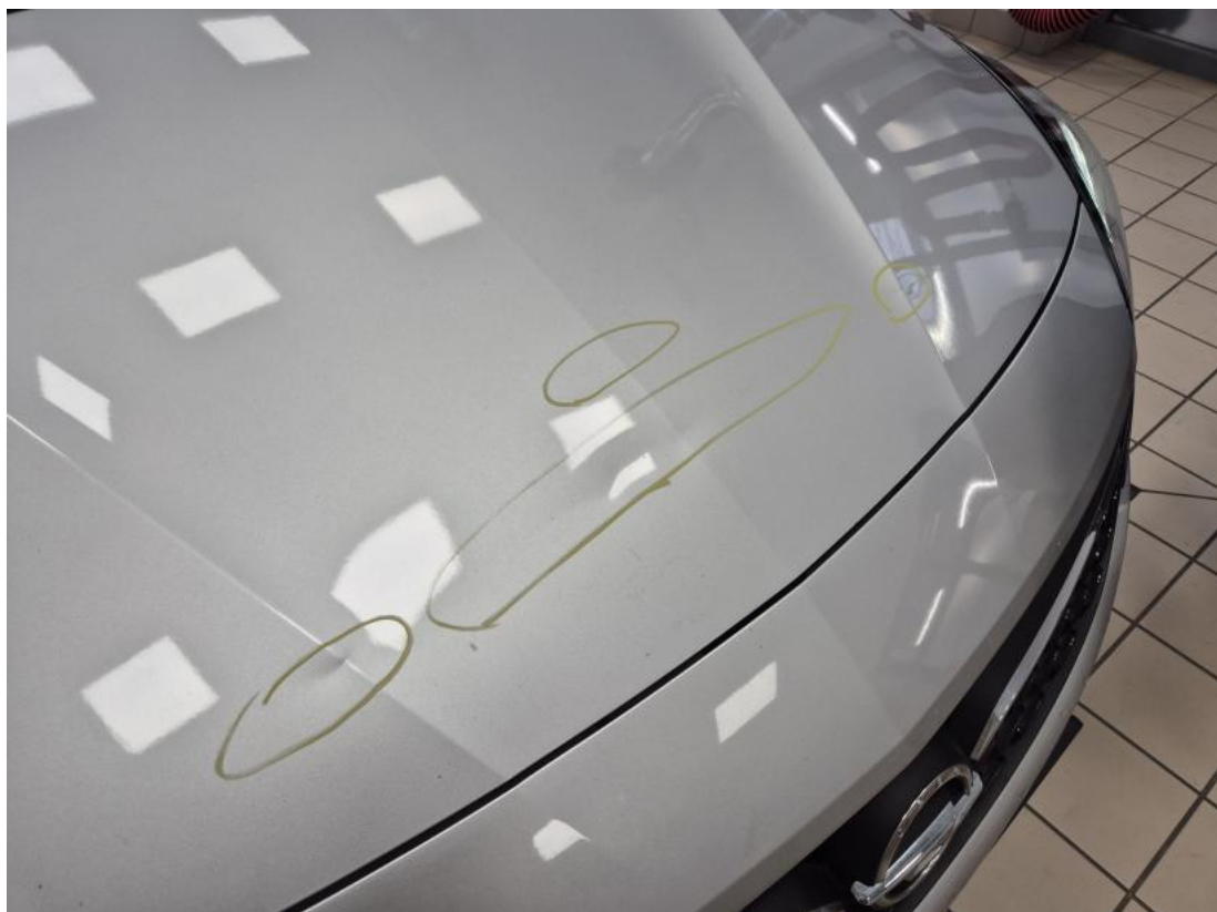
Fot. 34 Pokrywa komory silnika - Wgniecenie/odkształcenie 1
