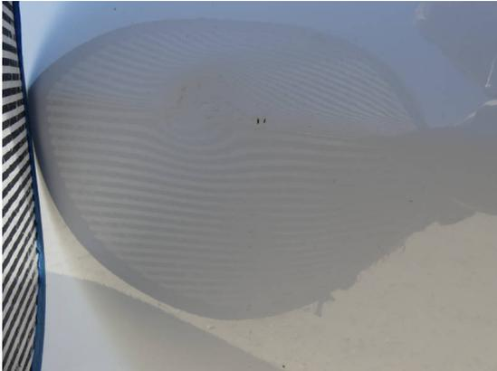
Bild 19: Karosserie / Tür vorne rechts leicht deformiert
