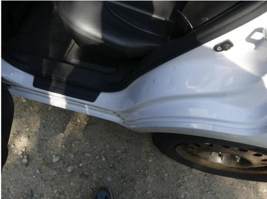
Bild 37: Karosserie / Türeinstieg hinten links Dellen und zerkratzt
