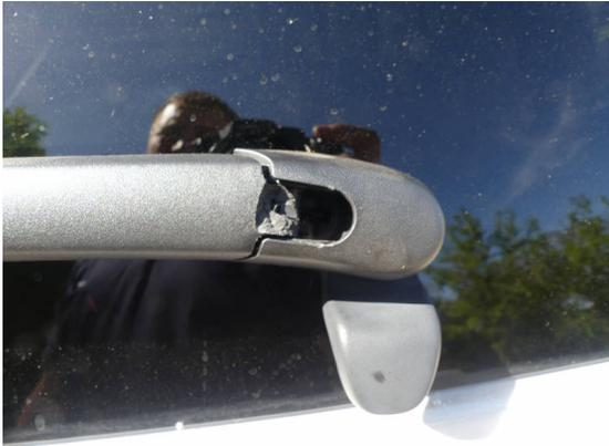
Bild 25: Technik / Wischerarm hinten gebrochen
