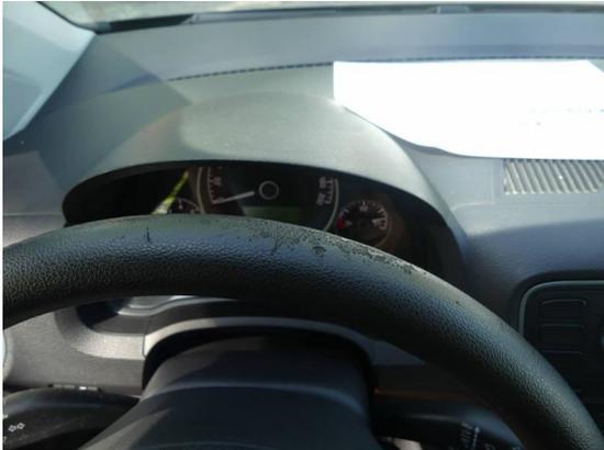
Bild 19: Innenraum / Lenkrad abgegriffen
