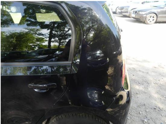
Bild 3: Karosserie / Seitenteil links Kratzer
