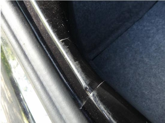
Bild 7: Karosserie / Kofferraumladekante zerkratzt
