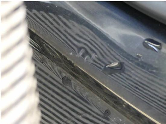
**Bild 33: Karosserie / Türeinstieg hinten links leicht deformiert und zerkratzt**
