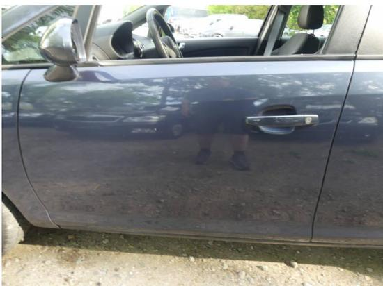
Bild 35: Karosserie / Tür vorne links zerkratzt
