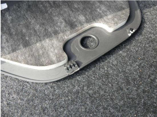
Bild 7: Innenraum / Abdeckung Kofferraum links Halteklammern abgebrochen
