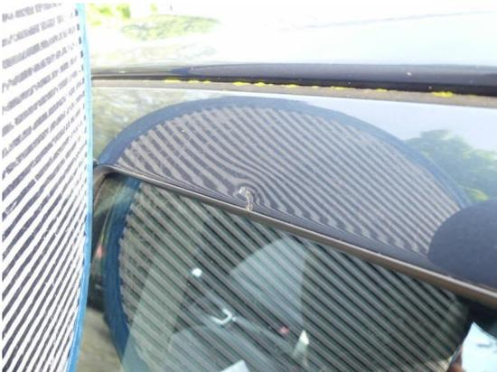
**Bild 39: Karosserie / Tür hinten links leicht deformiert und zerkratzt**
