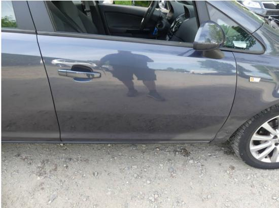
Bild 19: Karosserie / Tür vorne rechts leicht deformiert, zerkratzt und mit falscher Farbe
