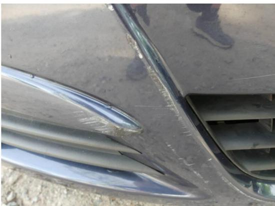
Bild 29: Karosserie / Stoßfänger vorn zerkratzt
