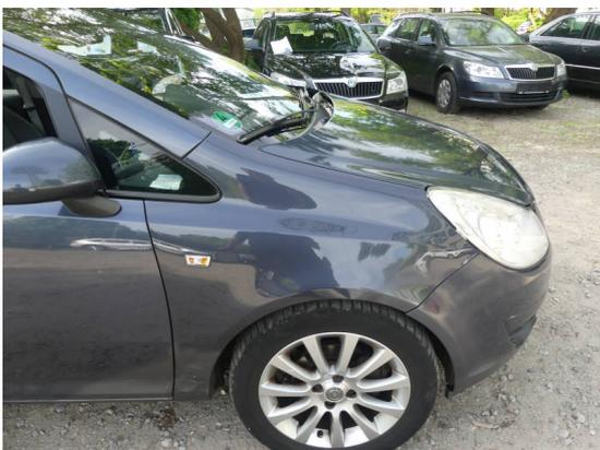
Bild 23: Karosserie / Kotflügel rechts deformiert, zerkratzt und mit falscher Farbe
