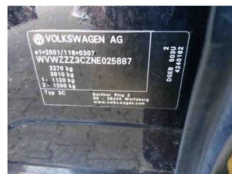
Fahrzeug - Typenschild/Fahrgestellnummer
