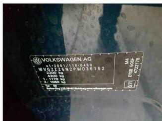
Fahrzeug - Typenschild/Fahrgestellnummer
