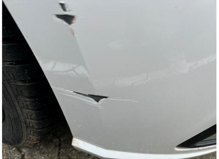
Stoßfänger vorne: verschrammt - instandsetzen (Foto 2)
