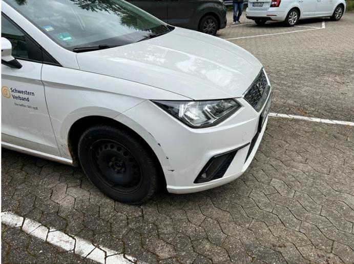
Stoßfänger vorne: verschrammt - instandsetzen (Foto 1)
