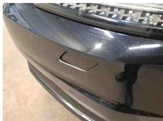
11 - Seitenwand hinten links - Delle(n) - Kaltdrücken
