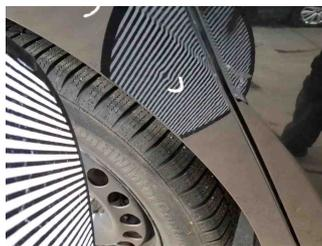
7 - Einstiegsschweller vorne links - Delle(n) - Instandsetzen + lackieren
