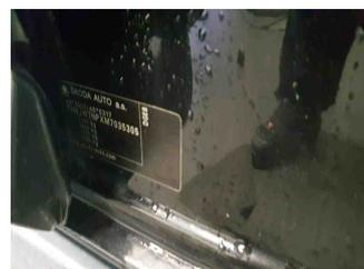
Fahrzeug - Typenschild/Fahrgestellnummer
