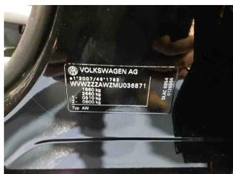
Fahrzeug - Typenschild/Fahrgestellnummer
