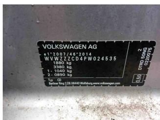
Fahrzeug - Typenschild/Fahrgestellnummer
