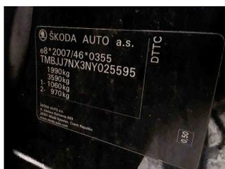
Fahrzeug - Typenschild/Fahrgestellnummer
