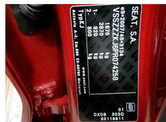
Fahrzeug - Typenschild/Fahrgestellnummer
