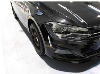
2 - Einstiegsschweller hinten rechts - Delle(n) und Kratzer - Instandsetzen + lackieren
