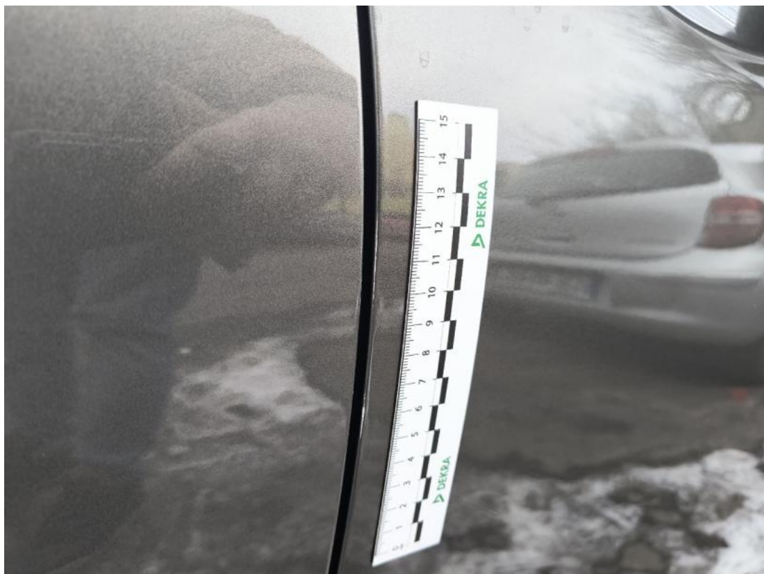
Fot. 42 Drzwi przednie P - Wgniecenie/odkształcenie 2
