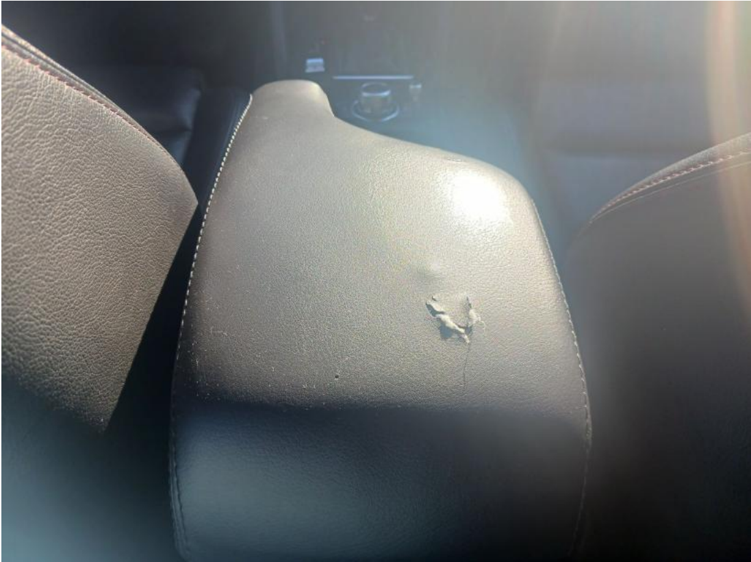
Fot. 65 Podłokietnik środkowy przedni - Pęknięcie/rozerwanie 1
