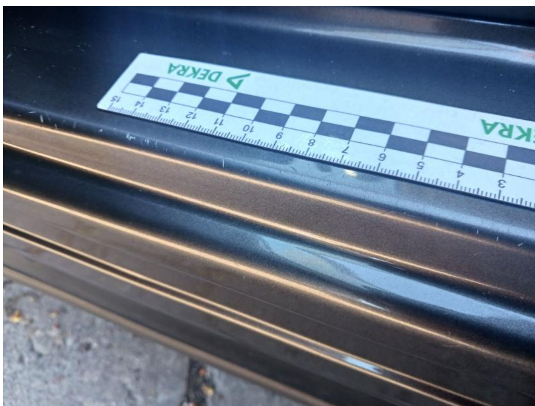
Fot. 64 Próg L - Rysa/odprysk 1
