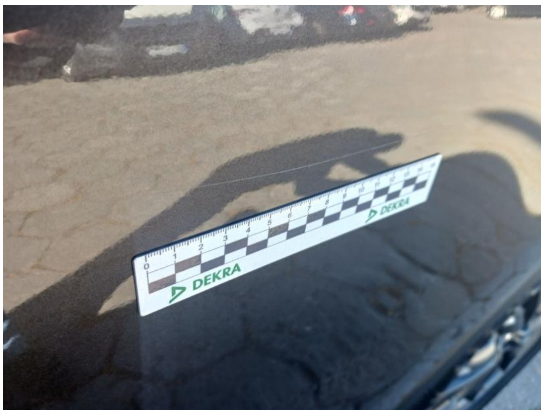
Fot. 63 Drzwi tylne L - Rysa/odprysk 1
