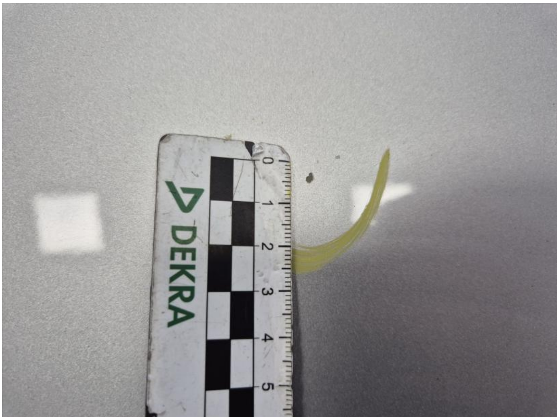
Fot. 34 Pokrywa komory silnika - Rysa/odprysk 1
