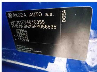
Fahrzeug - Typenschild/Fahrgestellnummer
