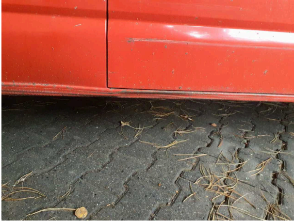
Beschädigung #6: Schweller rechts: Schweller - verformt - instandsetzen und lackieren
