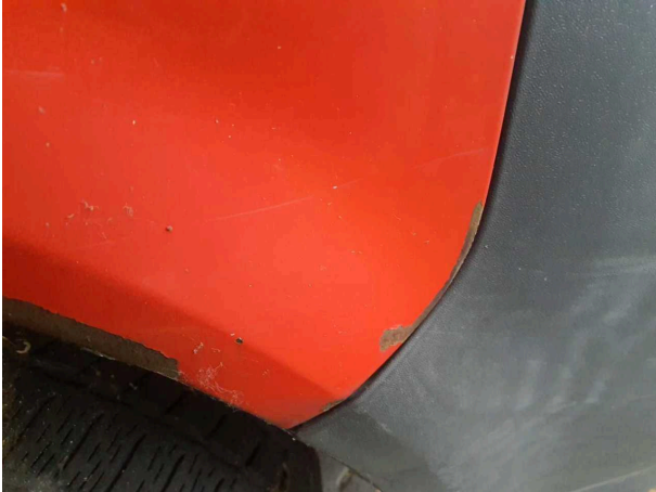
Beschädigung #3: Kotflügel rechts: Kotflügel rechts - Korrosion - lackieren
