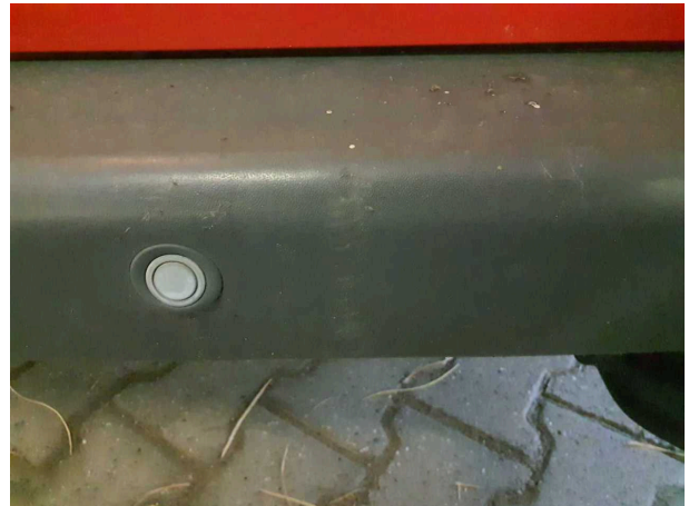
Beschädigung #2: Stossfänger hinten: Stossfänger hinten - verkratzt / verschürft - erneuern
