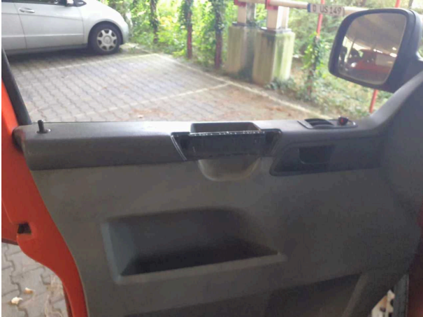
Beschädigung #1: Tür vorn links: Griff innen - fehlt - erneuern
