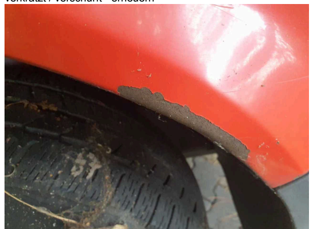
Beschädigung #3: Kotflügel rechts: Kotflügel rechts - Korrosion - lackieren
