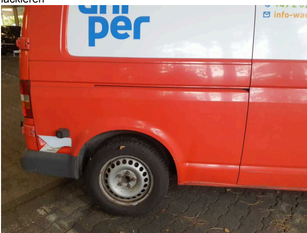
Beschädigung #5: Seitenwand rechts: Seitenwand - verkratzt / verschürft - instandsetzen und lackieren
