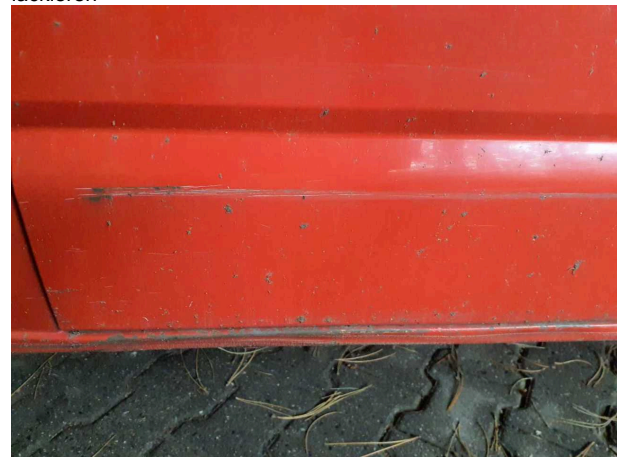
Beschädigung #4: Schiebetür rechts: Schiebetür - Korrosion - lackieren
