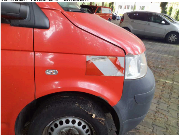
Beschädigung #3: Kotflügel rechts: Kotflügel rechts - Korrosion - lackieren
