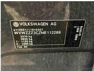
Fahrzeug - Typenschild/Fahrgestellnummer
