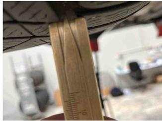
2 - Reifen hinten rechts - Verschlissen - Ersetzen
