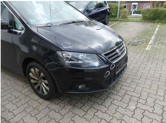
Bild 3: Karosserie / Stoßfänger vorne defekt
