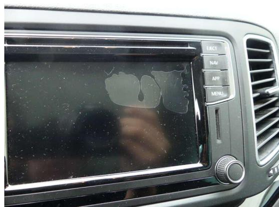
Bild 12: Innenraum / Display Radio/Navi defekt
