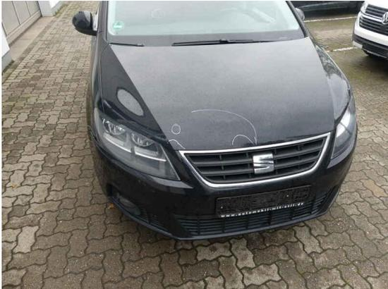
Bild 13: Karosserie / Motorhaube Delle
