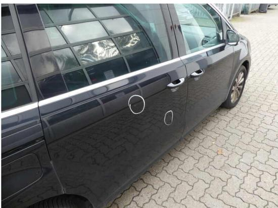
Bild 17: Karosserie / Tür hinten rechts Kratzer
