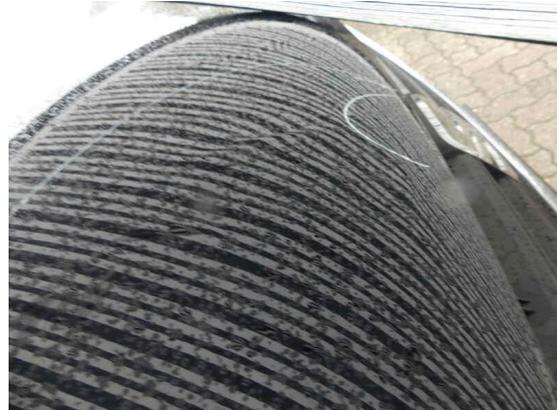
Bild 14: Karosserie / Motorhaube Delle
