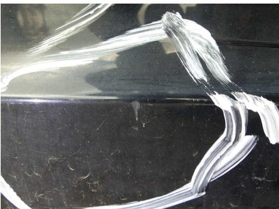
Bild 11: Karosserie / Stoßfänger hinten Beschädigt
