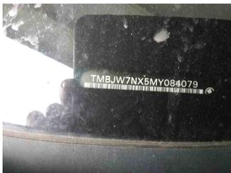
Fahrzeug - Typenschild/Fahrgestellnummer
