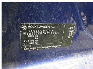
Fahrzeug - Typenschild/Fahrgestellnummer
