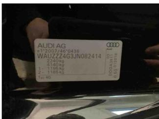
Fahrzeug - Typenschild/Fahrgestellnummer
