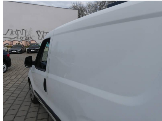
Bild 26: Karosserie / Seitenwand links Lack stumpf/matt
