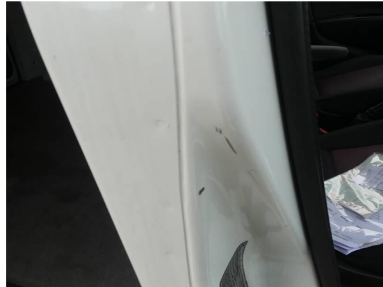
Bild 8: Karosserie / B-Säule rechts zerkratzt
