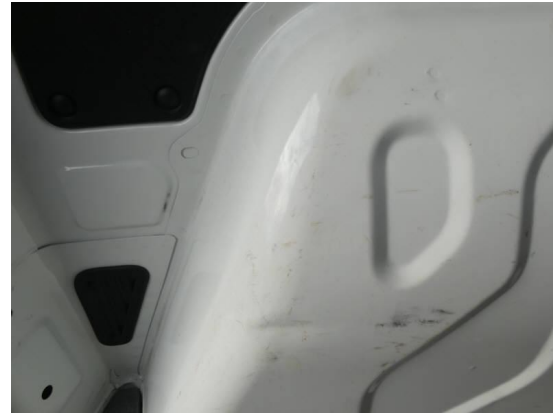
Bild 32: Karosserie / Laderaum Dellen und zerkratzt
