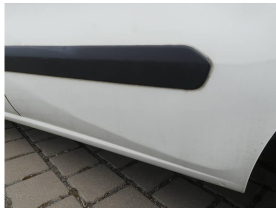
Bild 28: Karosserie / Seitenwand hinten links deformiert
