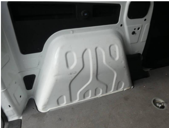
Bild 33: Karosserie / Laderaum Dellen und zerkratzt
