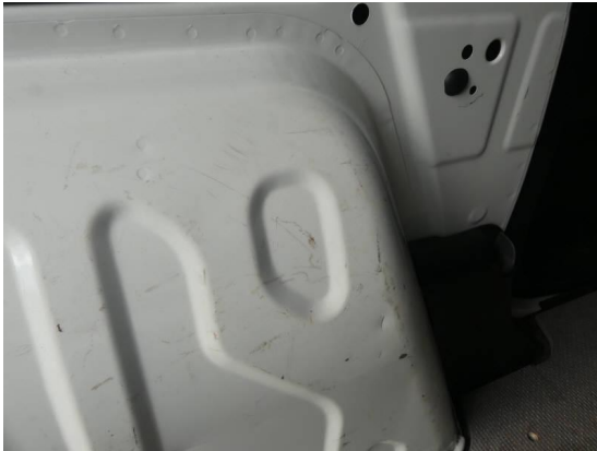
Bild 31: Karosserie / Laderaum Dellen und zerkratzt
