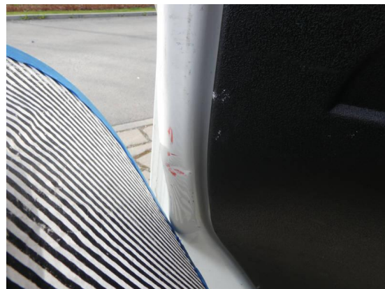
Bild 40: Karosserie / Hecktür links leicht deformiert und zerkratzt
