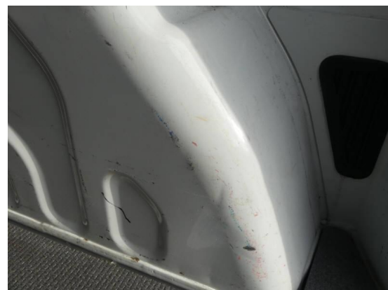
Bild 36: Karosserie / Laderaum Dellen und zerkratzt
