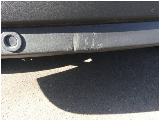
Bild 15: Karosserie / Stoßfänger hinten zerkratzt
