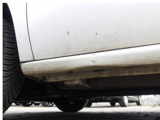
Bild 24: Karosserie / Schweller vorne links eingedrückt
