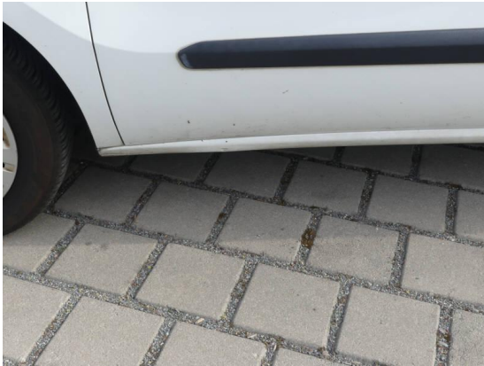
Bild 25: Karosserie / Schweller vorne links eingedrückt
