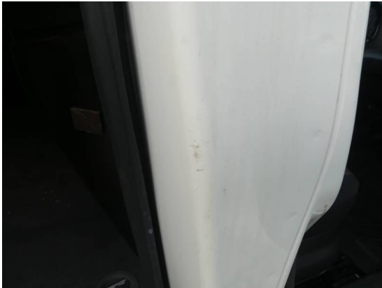
Bild 7: Karosserie / B-Säule rechts zerkratzt
