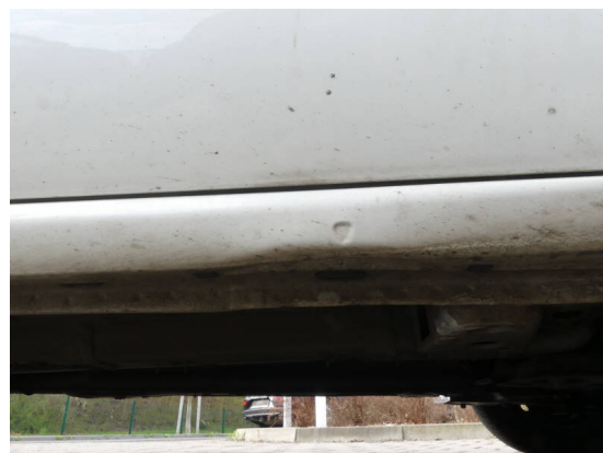
Bild 12: Karosserie / Schweller vorne rechts eingedrückt
