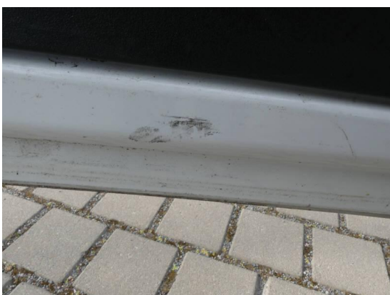
Bild 41: Karosserie / Hecktür links leicht deformiert und zerkratzt
