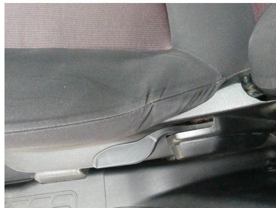
Bild 22: Innenraum / Fahrersitzpolster verschlissen
