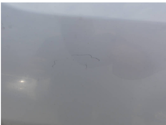
Bild 17: Karosserie / Motorhaube zerkratzt
