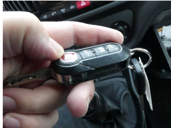
Bild 14: Technik / Schlüsselgehäuse gebrochen
