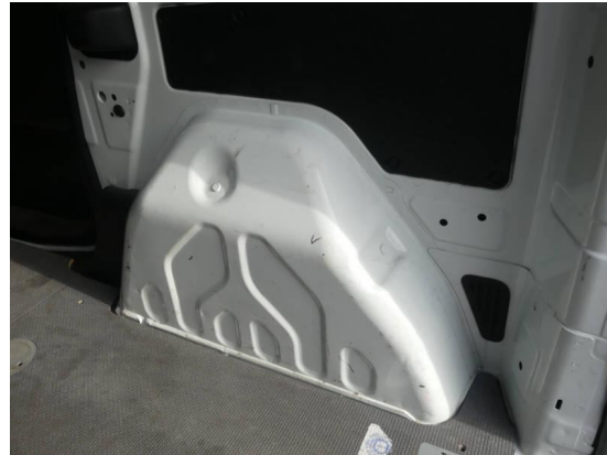
Bild 38: Karosserie / Laderaum Dellen und zerkratzt
