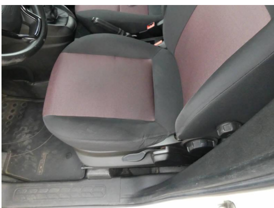
Bild 23: Innenraum / Fahrersitzpolster verschlissen
