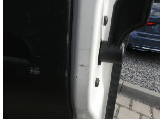
Bild 2: Karosserie / Hecktür rechts zerkratzt
