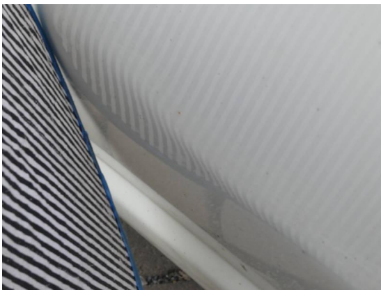
Bild 27: Karosserie / Seitenwand hinten links deformiert
