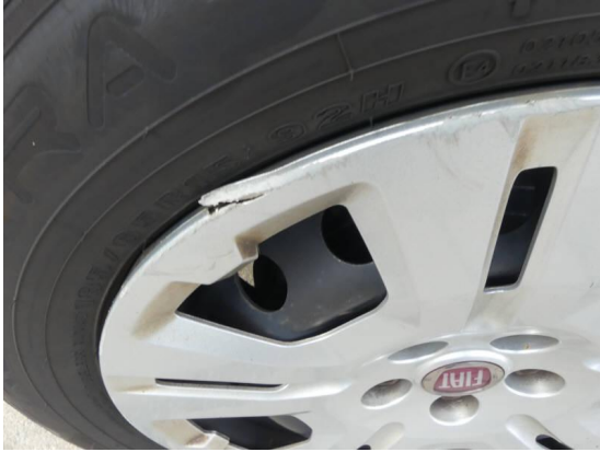
Bild 43: Reifen - Felge / Radkappe hinten rechts gebrochen
