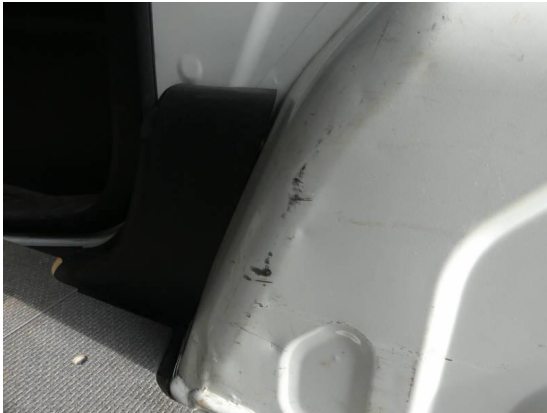
Bild 37: Karosserie / Laderaum Dellen und zerkratzt
