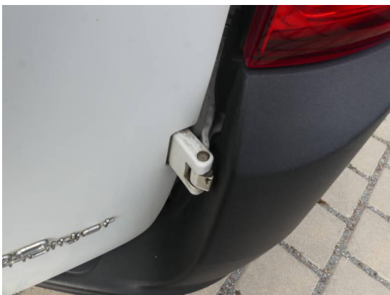
Bild 5: Technik / Hecktür rechts schwergängig
