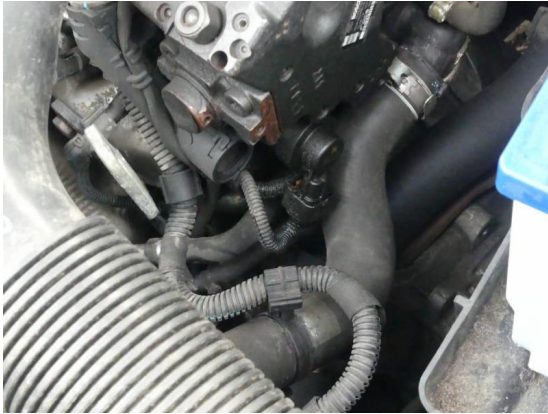
Bild 1: Technik / Motorraum verölt
