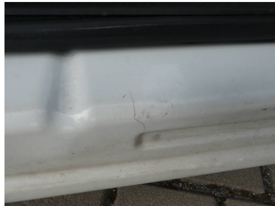
Bild 10: Karosserie / Türeinstieg vorne rechts zerkratzt
