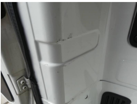
Bild 35: Karosserie / Laderaum Dellen und zerkratzt
