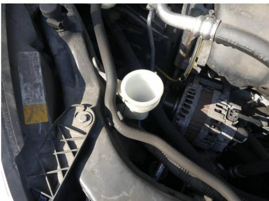
Bild 53: Technik / Deckel Scheibenwaschbehälter fehlt
