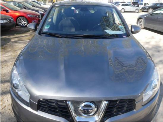
Bild 37: Karosserie / Motorhaube Dellen und zerkratzt
