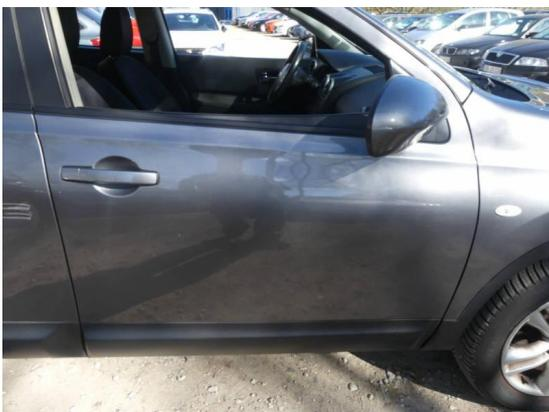
Bild 23: Karosserie / Tür vorne rechts zerkratzt
