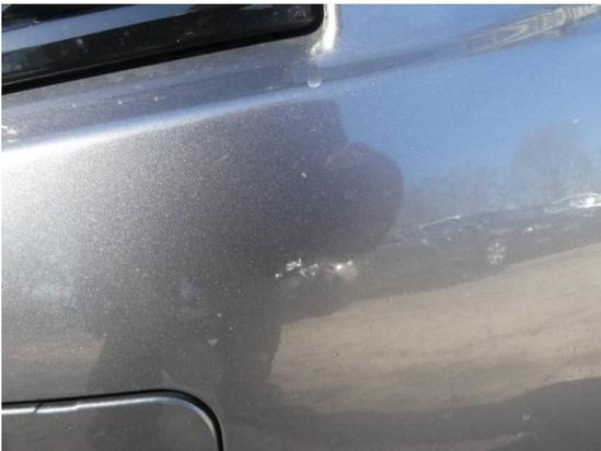
Bild 39: Karosserie / Stoßfänger vorn zerkratzt
