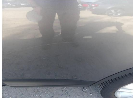
Bild 2: Karosserie / Tür hinten links zerkratzt
