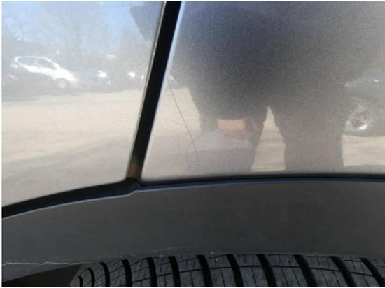
Bild 7: Karosserie / Seitenwand links zerkratzt
