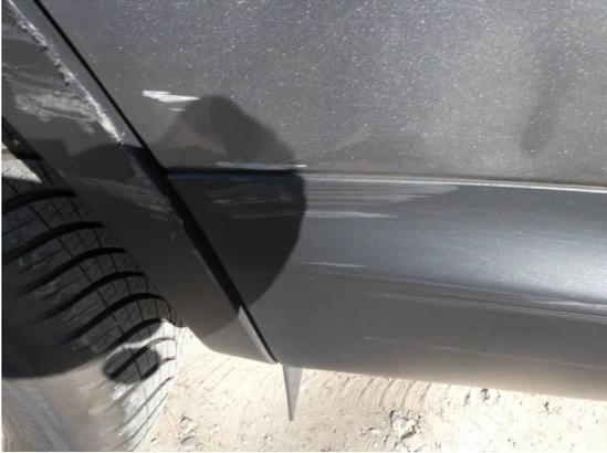
Bild 61: Karosserie / Tür hinten rechts stark deformiert und Loch
