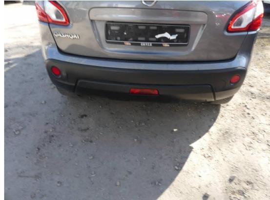
Bild 14: Karosserie / Stoßfänger hinten gebrochen
