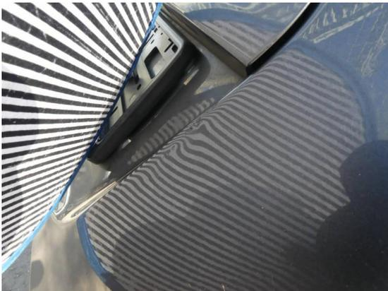
Bild 15: Karosserie / Heckklappe leicht deformiert und zerkratzt
