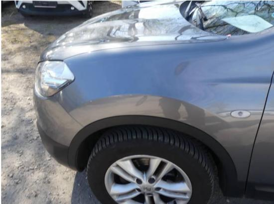
Bild 43: Karosserie / Kotflügel links Kratzer
