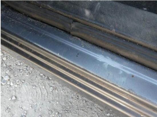
Bild 49: Karosserie / Türeinstieg vorne links zerkratzt
