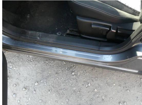
Bild 50: Karosserie / Türeinstieg vorne links zerkratzt
