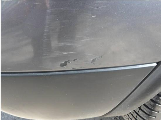
Bild 13: Karosserie / Stoßfänger hinten gebrochen
