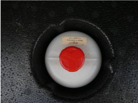
Bild 55: Reifen - Felge / Reifendichtmittel abgelaufen
