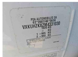
Fahrzeug - Typenschild/Fahrgestellnummer
