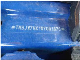
Fahrzeug - Typenschild/Fahrgestellnummer
