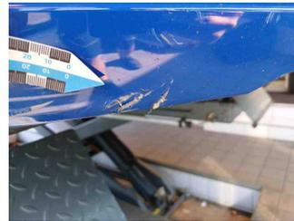
3 - Stoßfänger hinten - Delle(n) und Kratzer - Lackieren
