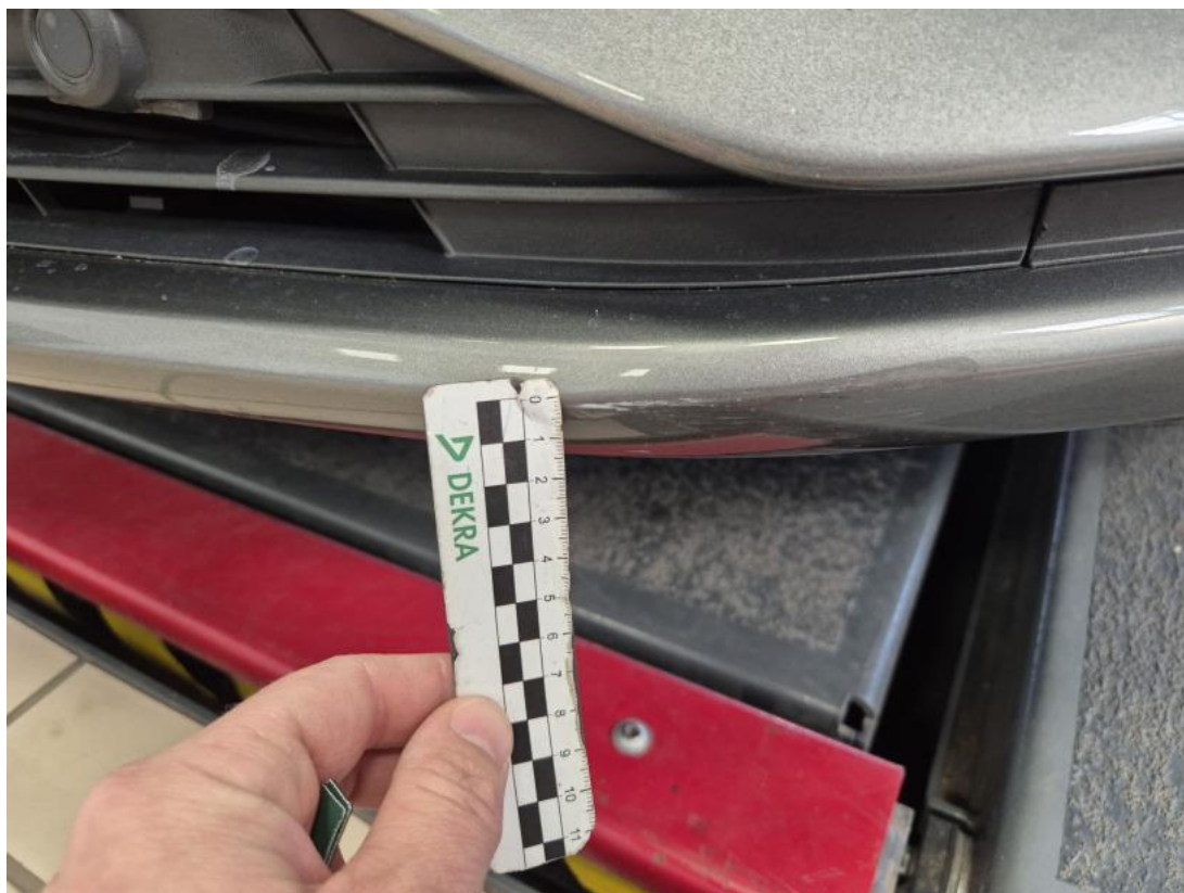
Fot. 37 Zderzak - Rysa/odprysk 1
