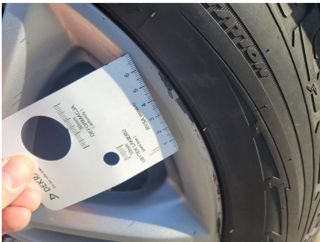
Fot. 44 Felga aluminiowa tylna L - Rysa/odprysk 1
