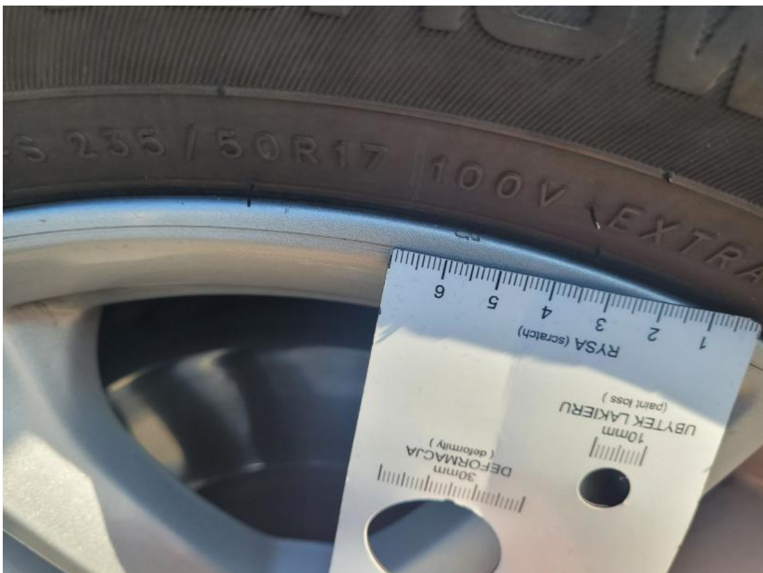
Fot. 48 Felga Aluminiowa przednia L - Rysa/odprysk 1
