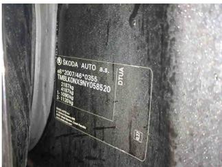
Fahrzeug - Typenschild/Fahrgestellnummer
