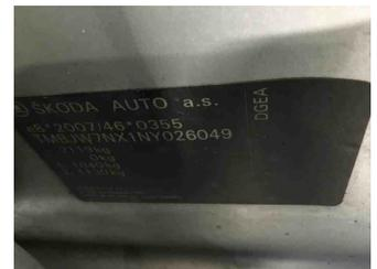
Fahrzeug - Typenschild/Fahrgestellnummer
