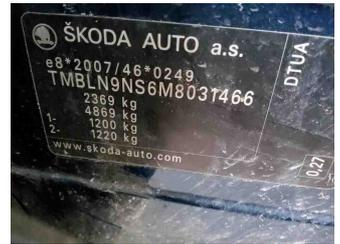
Fahrzeug - Typenschild/Fahrgestellnummer
