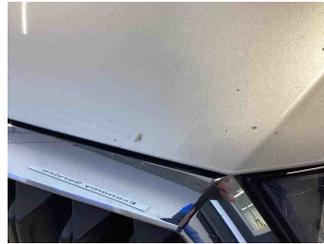
2 - Stoßfänger hinten - Blasenbildung - Instandsetzen + lackieren
