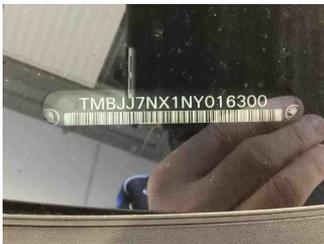
Fahrzeug - Typenschild/Fahrgestellnummer
