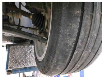
11 - Reifen vorne rechts - Außerhalb Toleranzbereich - Ersetzen
