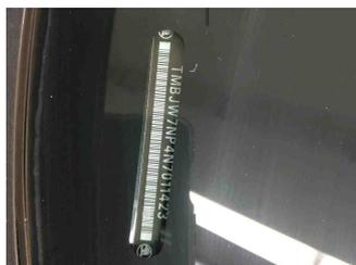
Fahrzeug - Typenschild/Fahrgestellnummer
