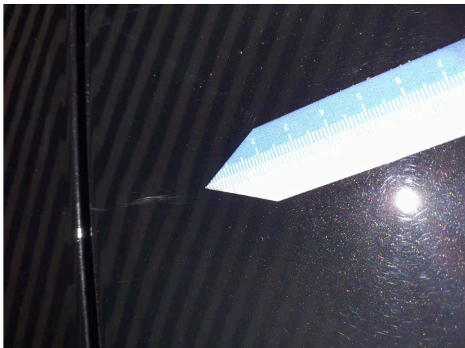
Beschädigung 7: Tür hinten links: Tür - Delle / Lackschaden - instandsetzen und lackieren
