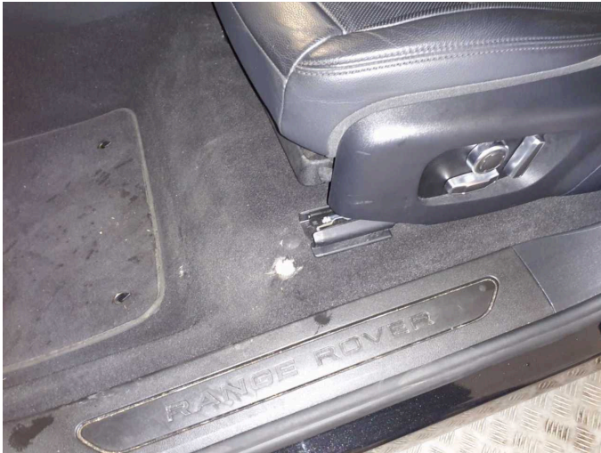
Beschädigung 5: Verkleidungen/Abdeckungen: Teppichboden vorn links - gebrochen / gerissen - erneuern
