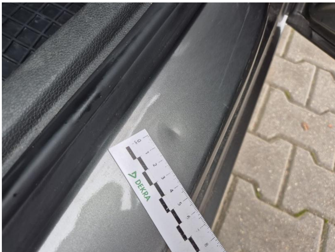
Fot. 47 Próg P() - Wgniecenie/odkształcenie 3
