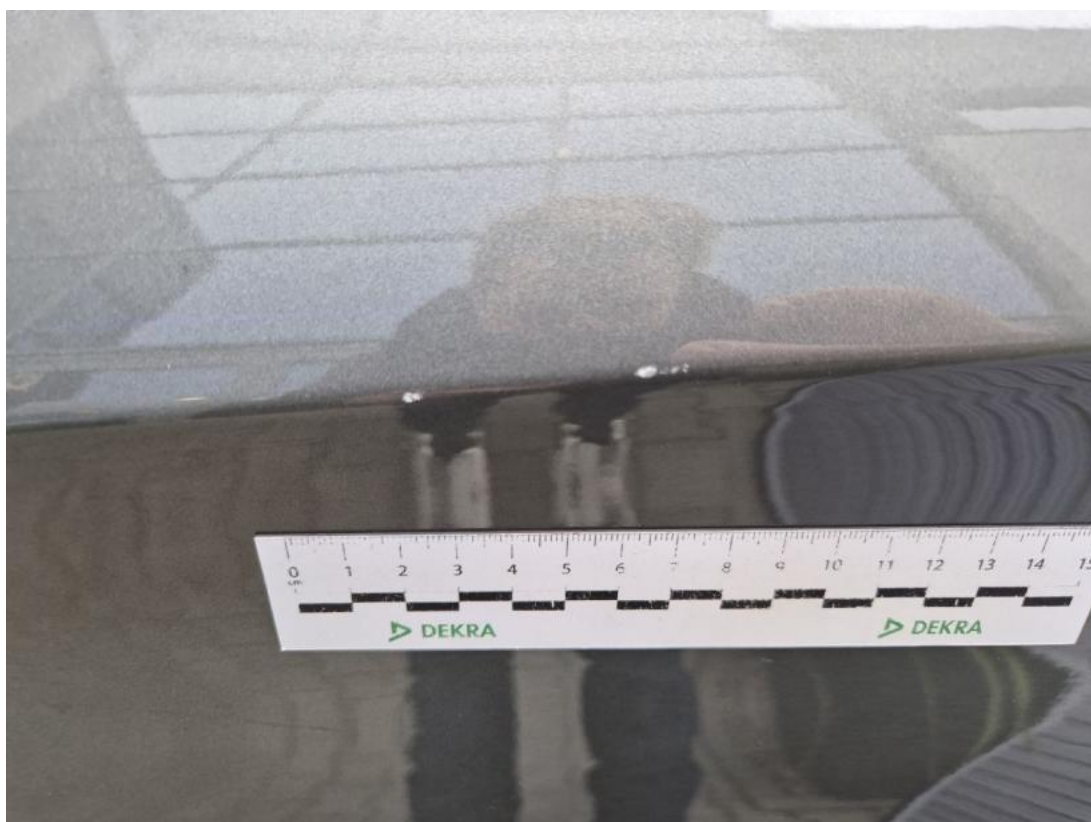
Fot. 61 Drzwi tylne L - Rysa/odprysk 2
