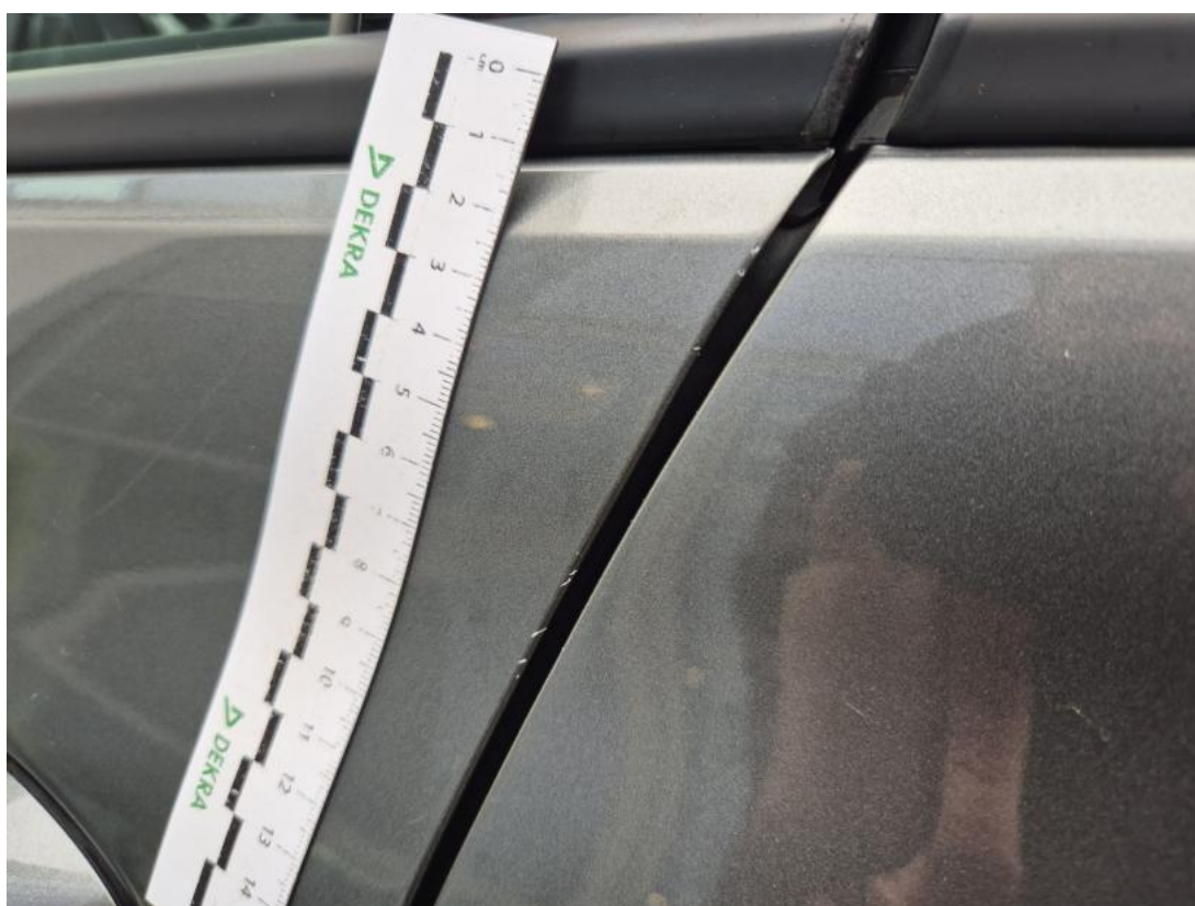
Fot. 58 Drzwi przed L - Rysa/odprysk 2
