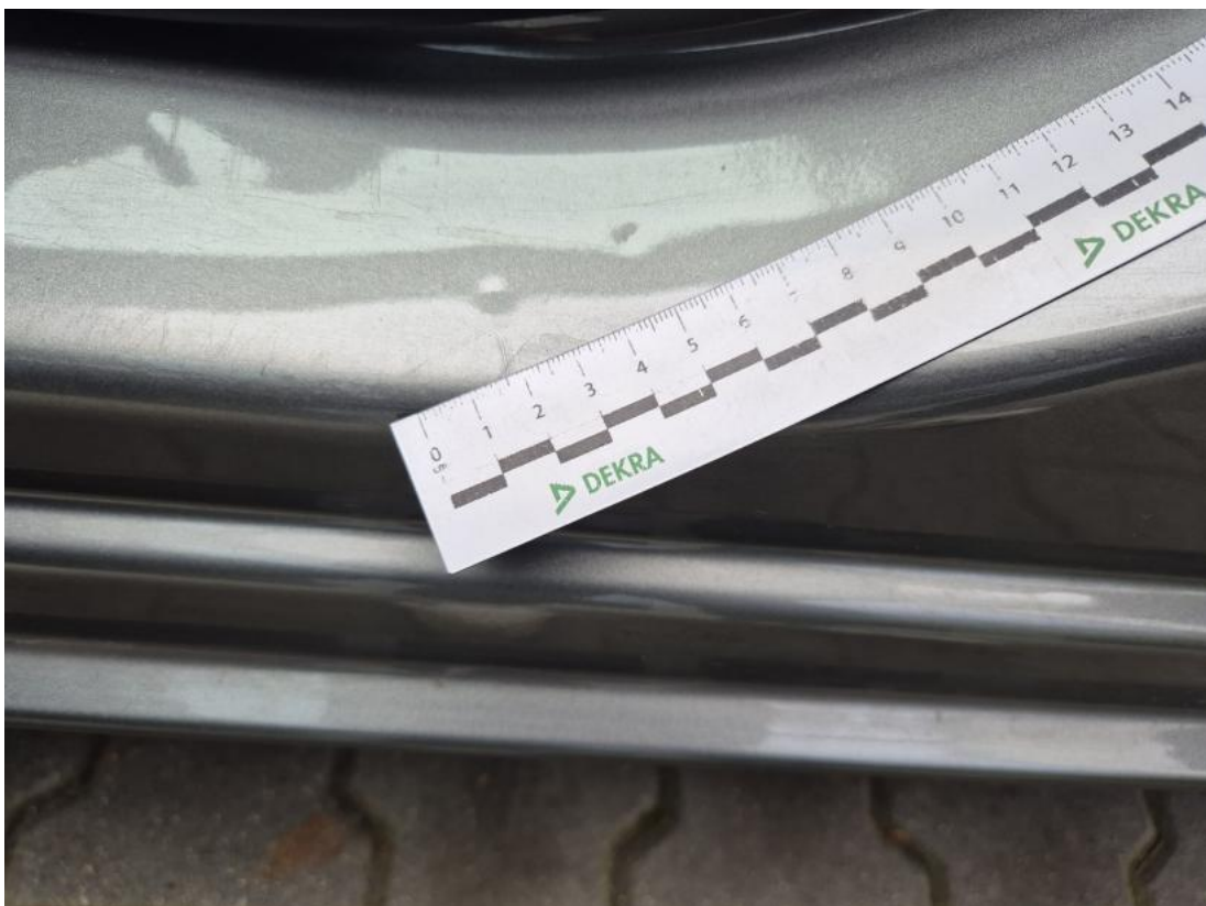
Fot. 64 Próg L - Wgniecenie/odkształcenie 1
