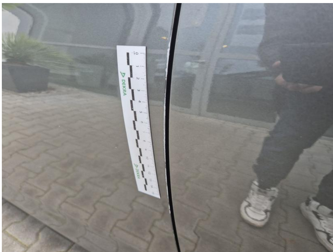
Fot. 57 Drzwi przed L - Rysa/odprysk 1
