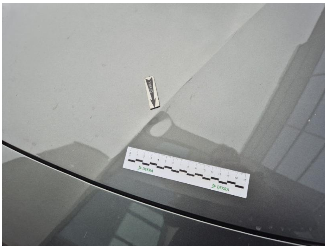
Fot. 33 Pokrywa komory silnika - Wgniecenie/odkształcenie 1
