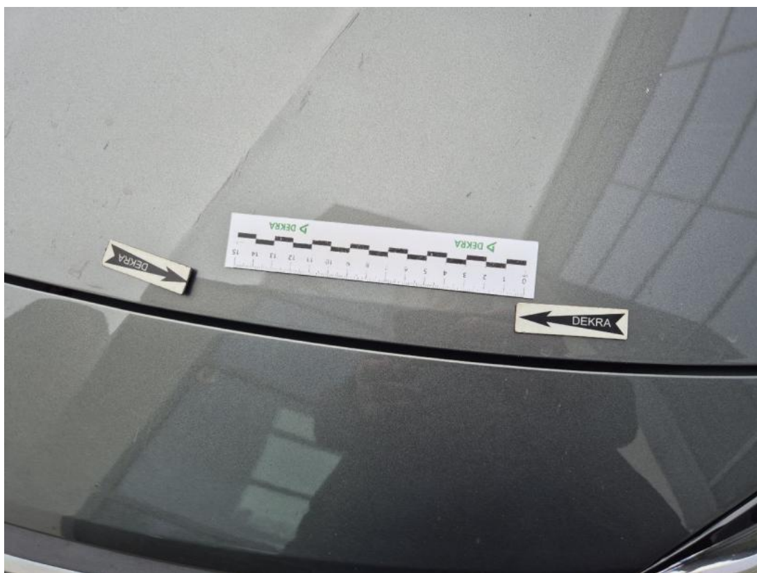
Fot. 34 Pokrywa komory silnika - Wgniecenie/odkształcenie 2
