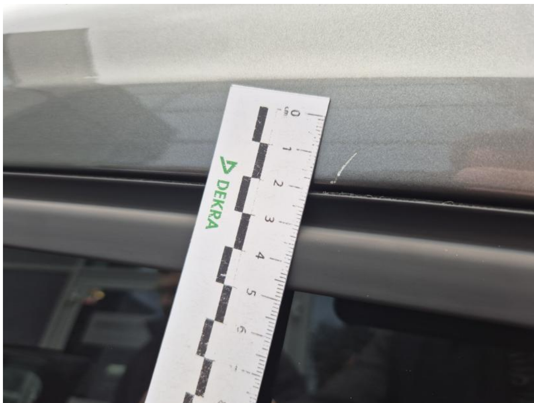
Fot. 53 Rama dachu L - Rysa/odprysk 1
