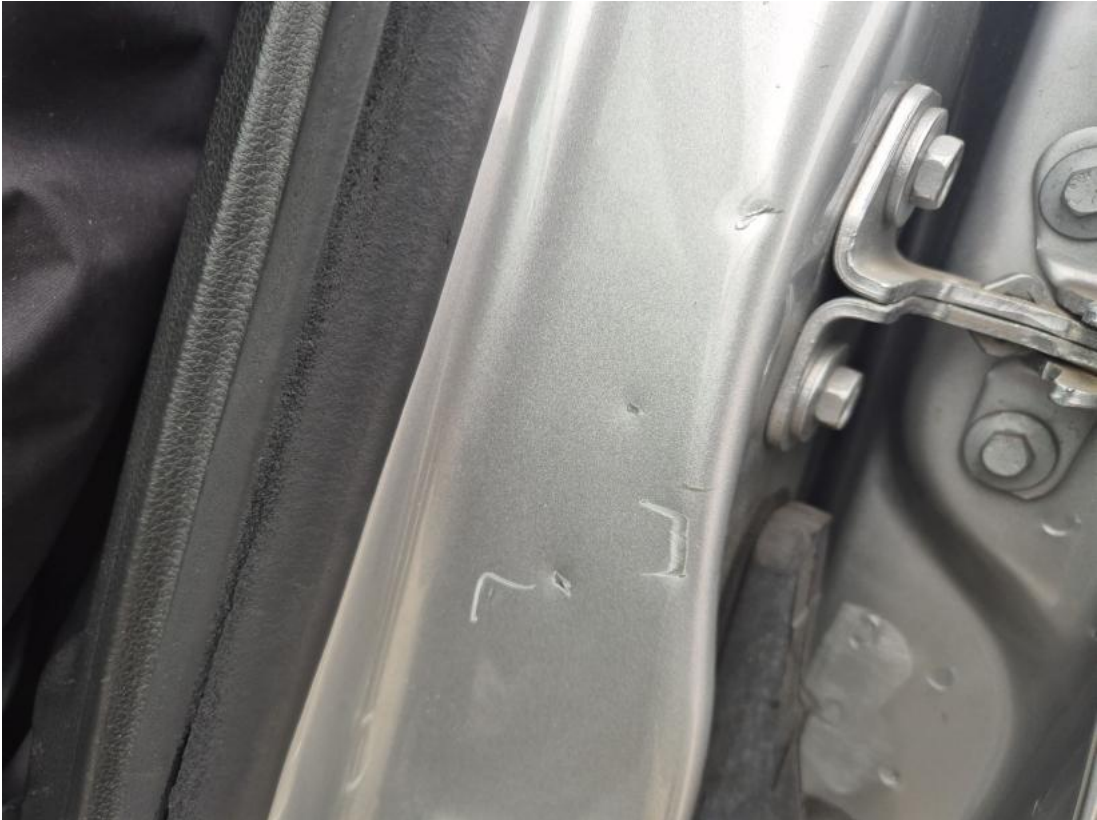
Fot. 49 Słupek środkowy L - Rysa/odprysk 1
