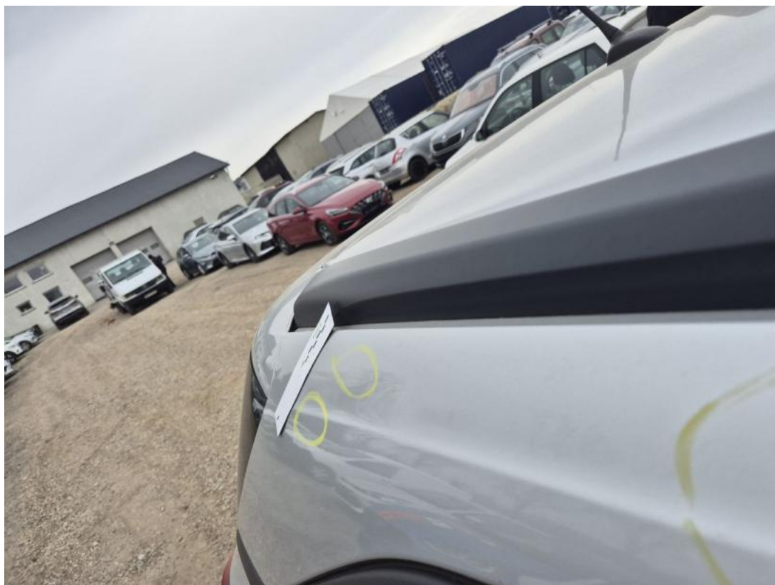
Fot. 43 Rama dachu P - Wgniecenie/odkształcenie 2
