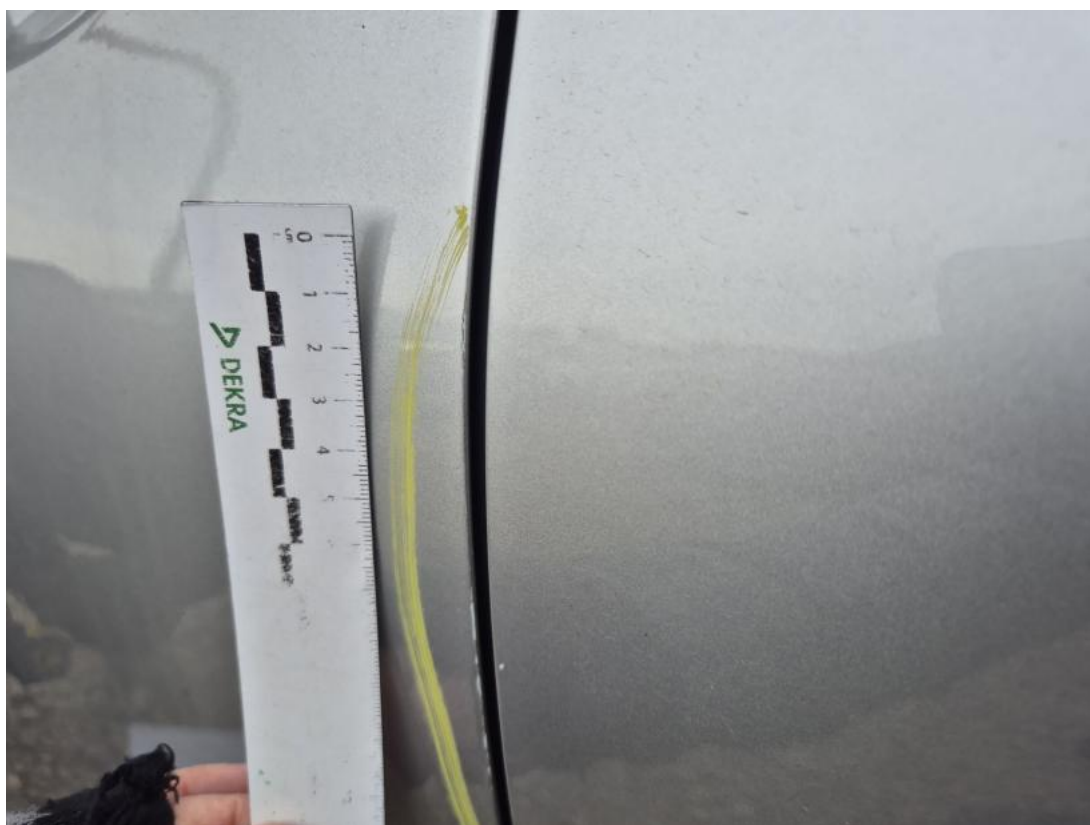
Fot. 44 Drzwi przed L - Rysa/odprysk 1
