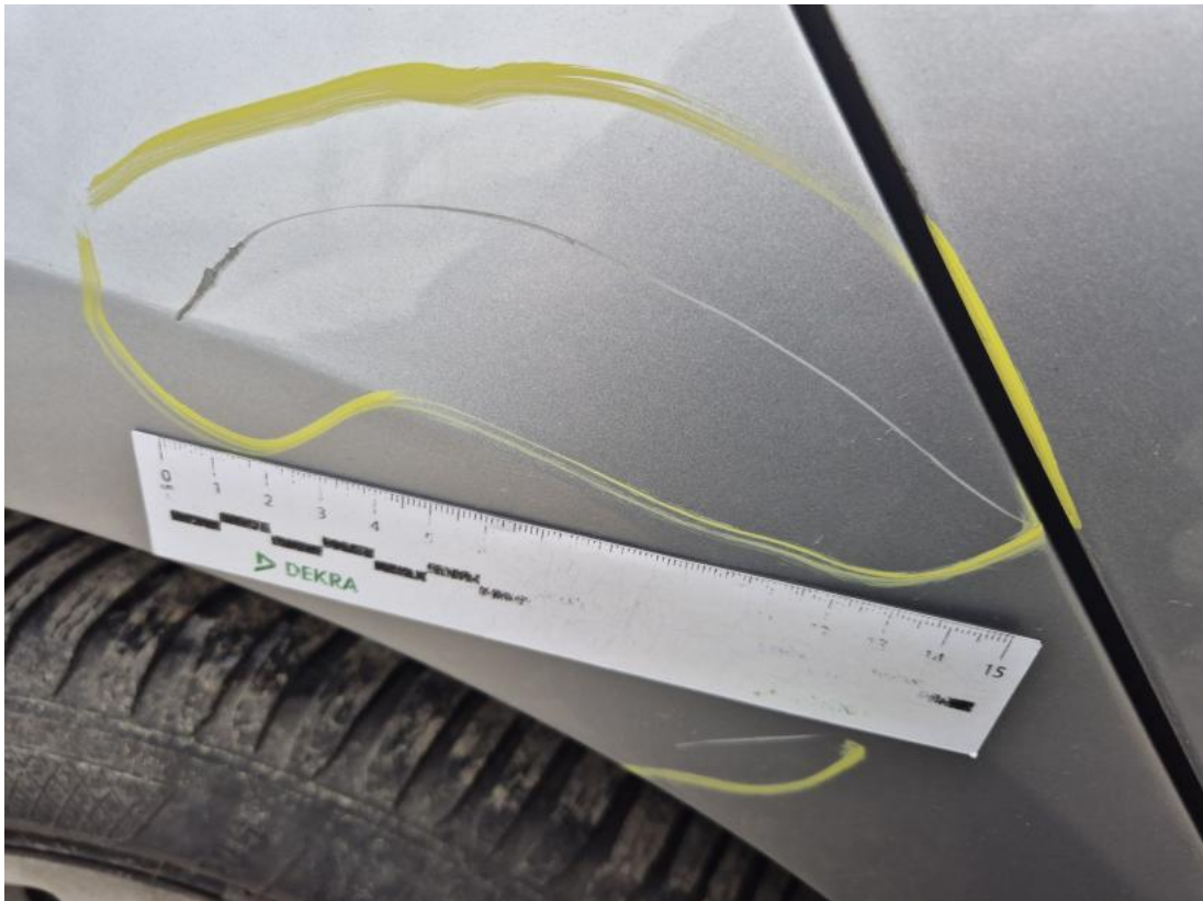
Fot. 37 Błotnik tylny P / Ściana boczna P - Rysa/odprysk 1
