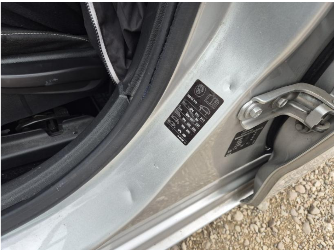
Fot. 50 Słupek środkowy L - Wgniecenie/odkształcenie 1
