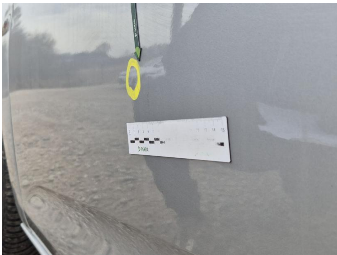
Fot. 46 Drzwi przed L - Wgniecenie/odkształcenie 1
