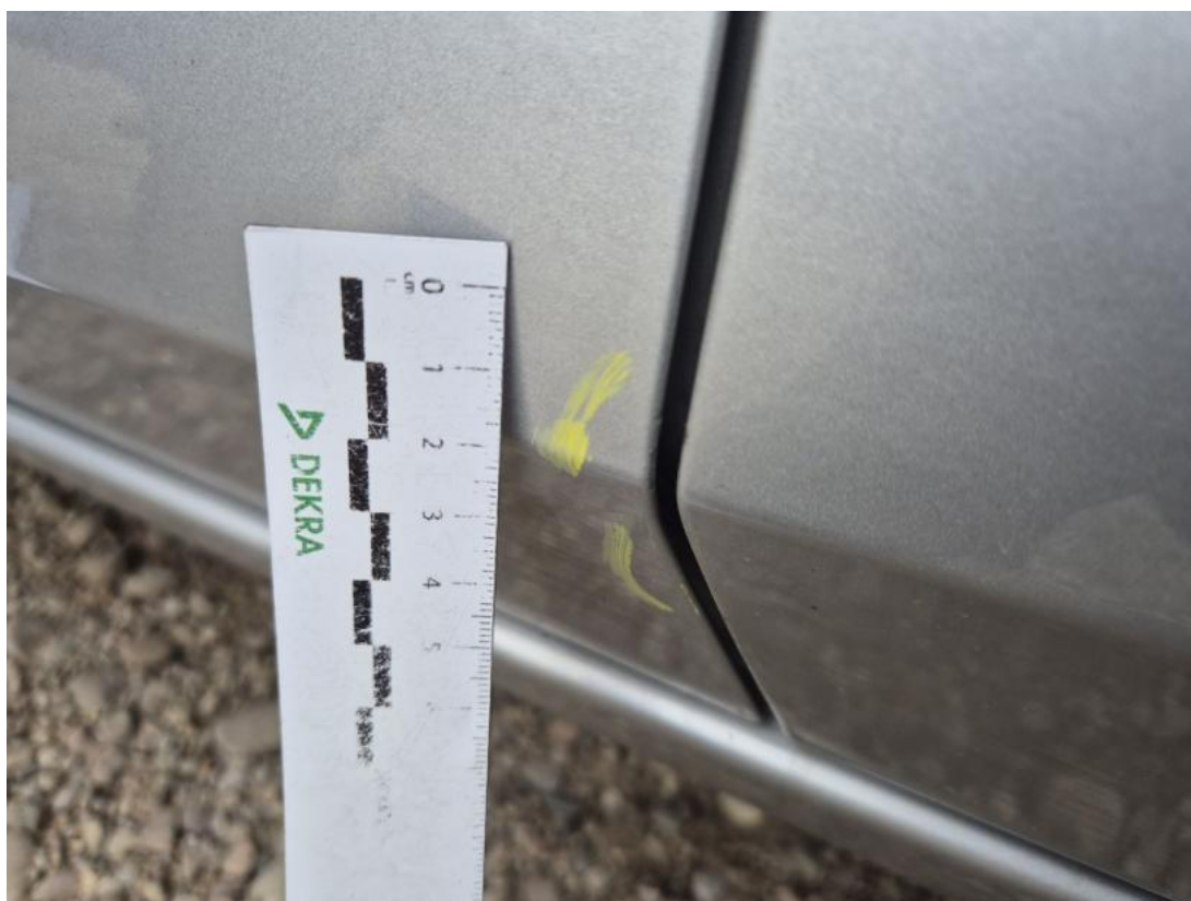
Fot. 45 Drzwi przed L - Rysa/odprysk 2
