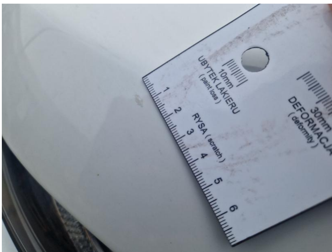
Fot. 36 Pokrywa komory silnika - Rysa/odprysk 1
