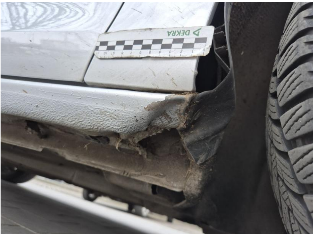
Fot. 40 Próg P - Wgniecenie/odkształcenie 1
