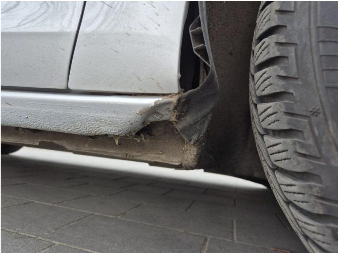
Fot. 39 Nadkole przednie P - Wgniecenie/odkształcenie 1
