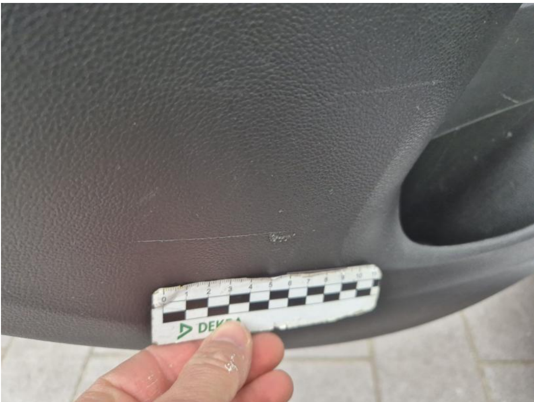
Fot. 50 Tapicerka drzwi tylnych L - Rysa/odprysk 1
