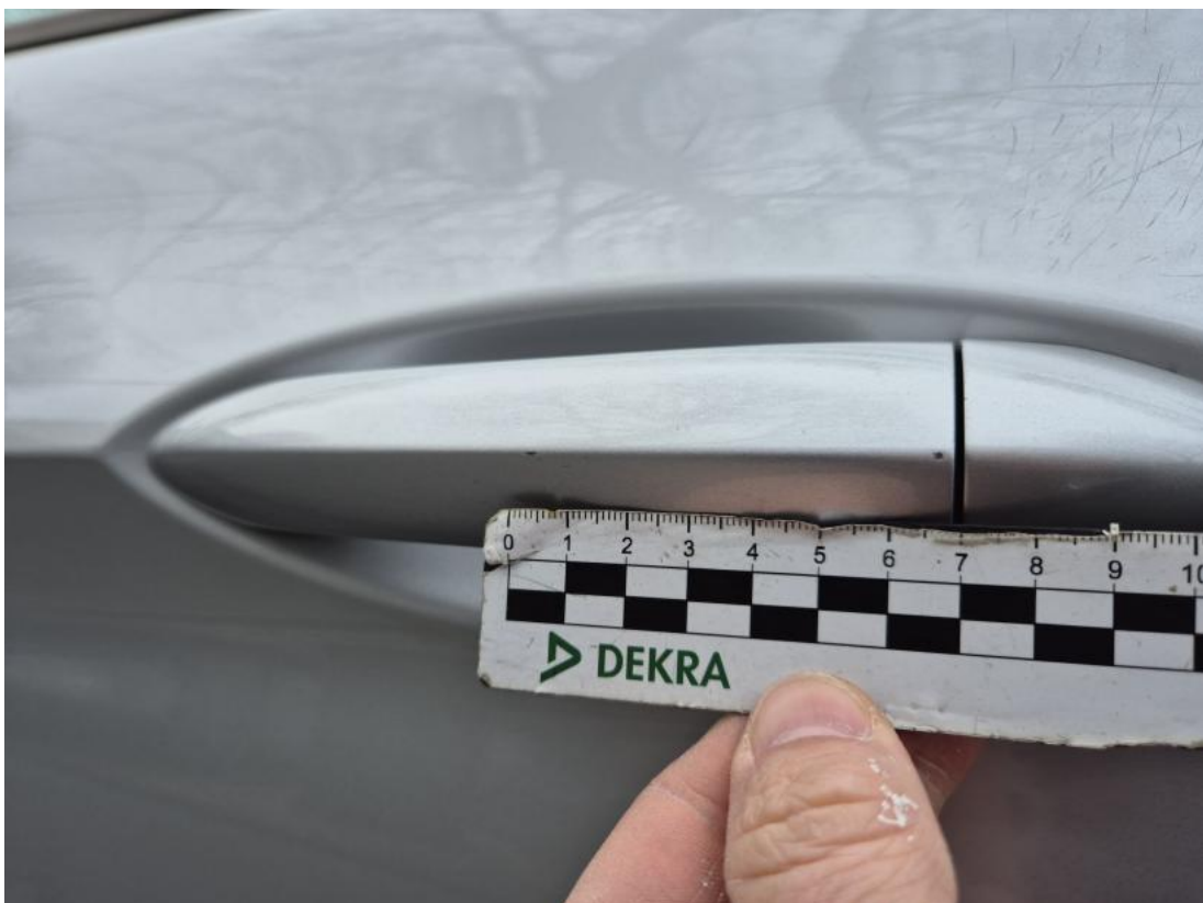
Fot. 48 Klamka drzwi prz L - Rysa/odprysk 1
