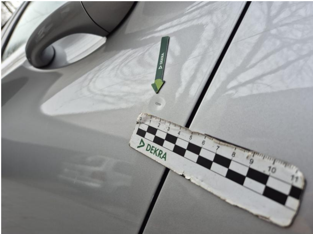
Fot. 47 Drzwi tylne L - Wgniecenie/odkształcenie 1
