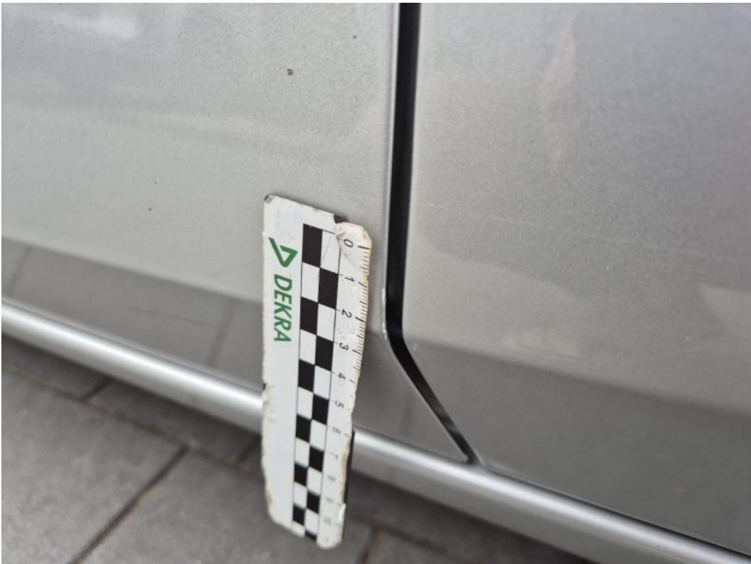
Fot. 45 Drzwi przed L() - Rysa/odprysk 3
