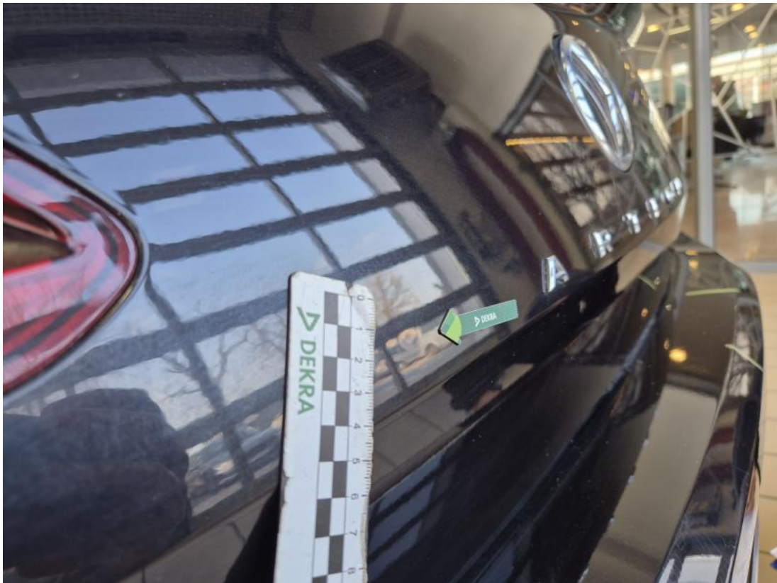
Fot. 41 Pokrywy bagażnika - Wgniecenie/odkształcenie 1
