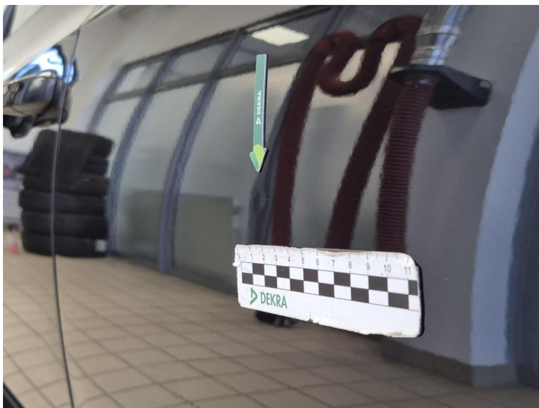
Fot. 43 Drzwi tylne L - Wgniecenie/odkształcenie 1
