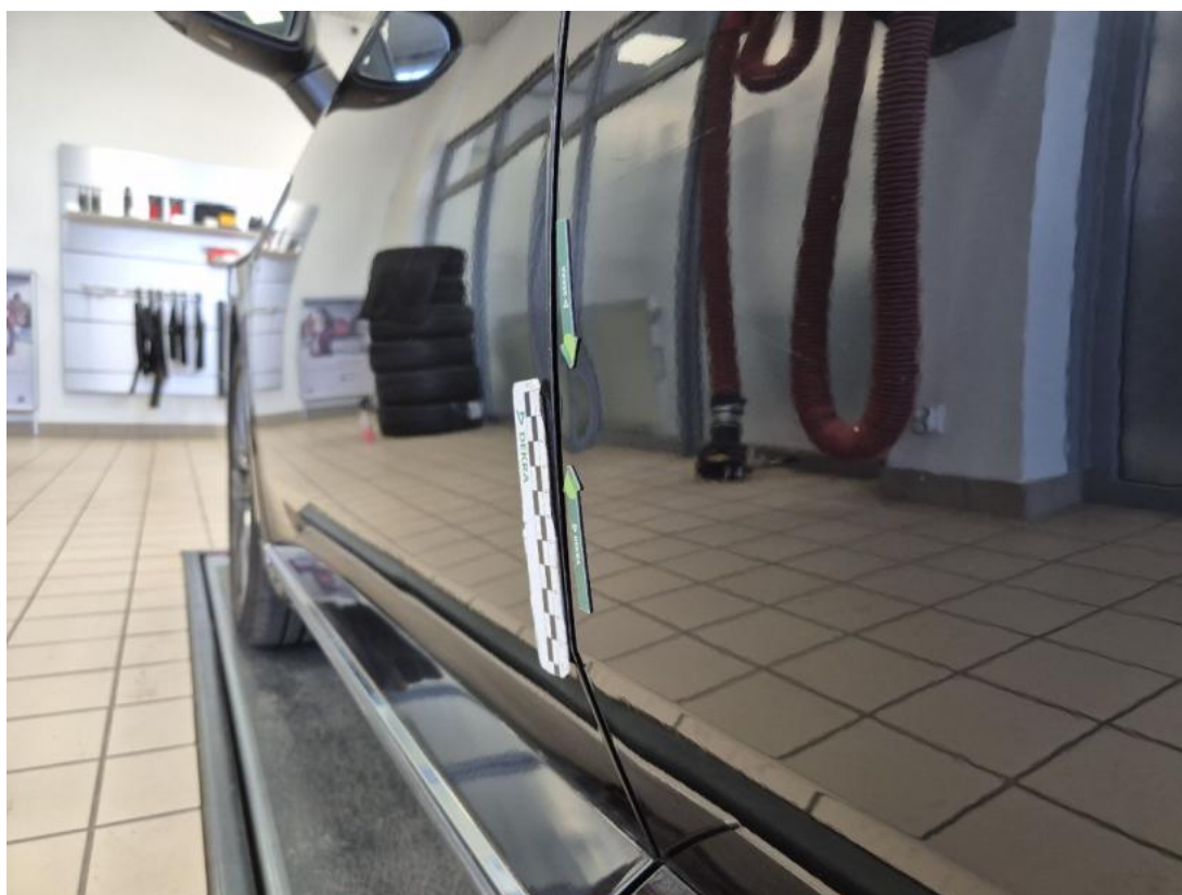
Fot. 44 Drzwi tylne L - Wgniecenie/odkształcenie 2
