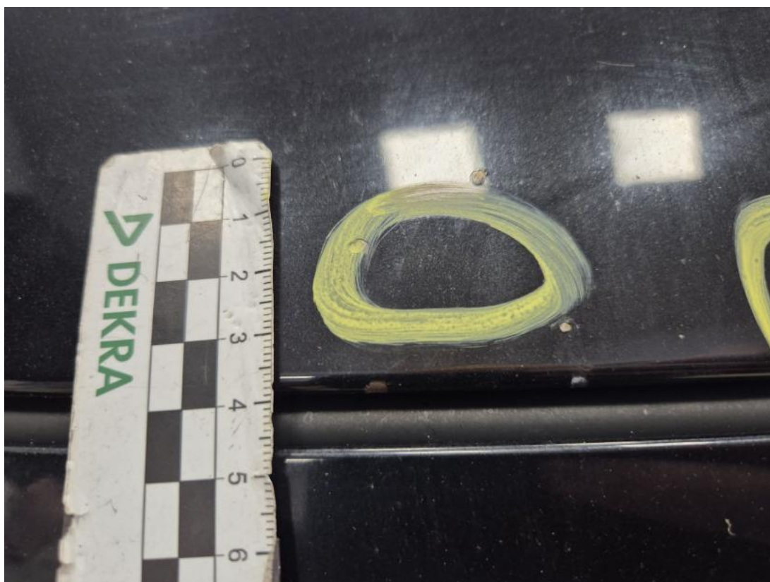
Fot. 35 Pokrywa komory silnika - Rysa/odprysk 1
