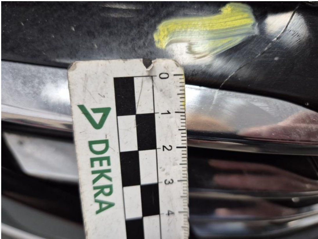
Fot. 33 Atrapa przednia - Pęknięcie/rozerwanie 2
