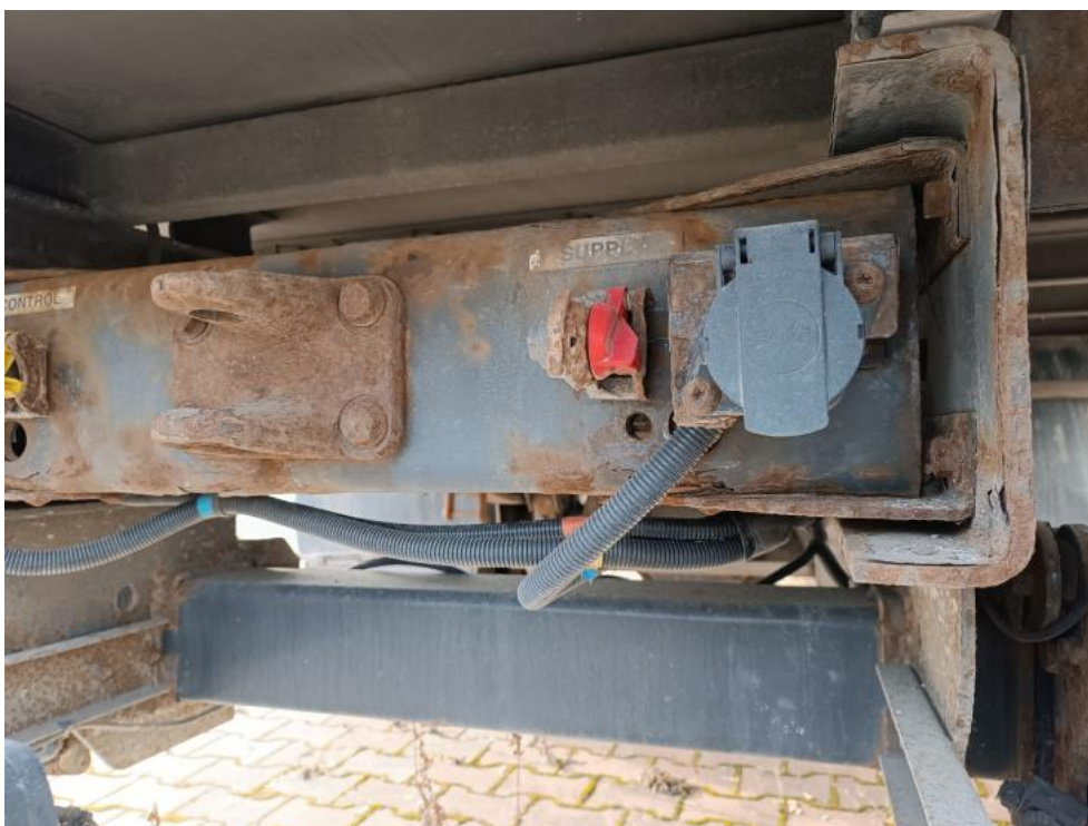
Fot. 50. belka tylna korozja
