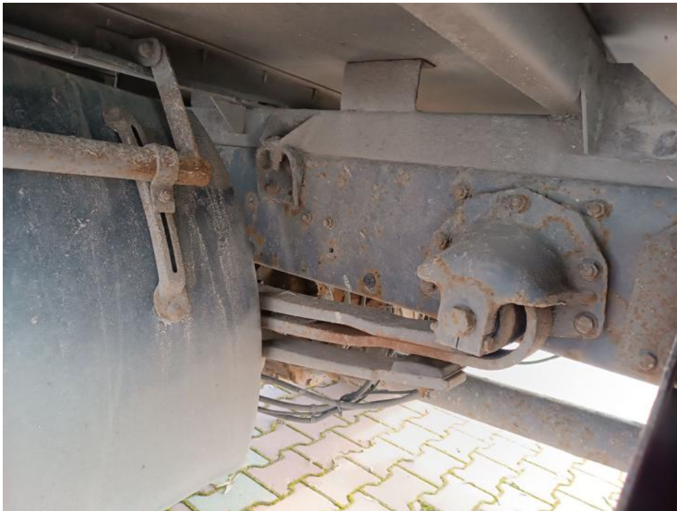
Fot. 87. Rama() - korozja 3
