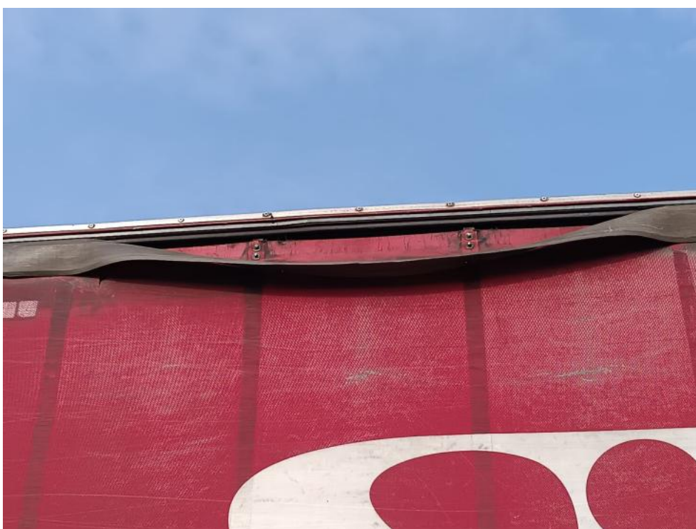
Fot. 54. plandeka lewa strona uszkodzona góra
