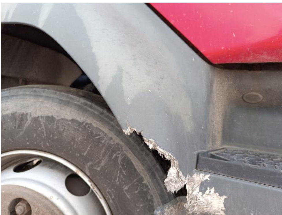
Fot. 45. nadkole prawe rozerwane
