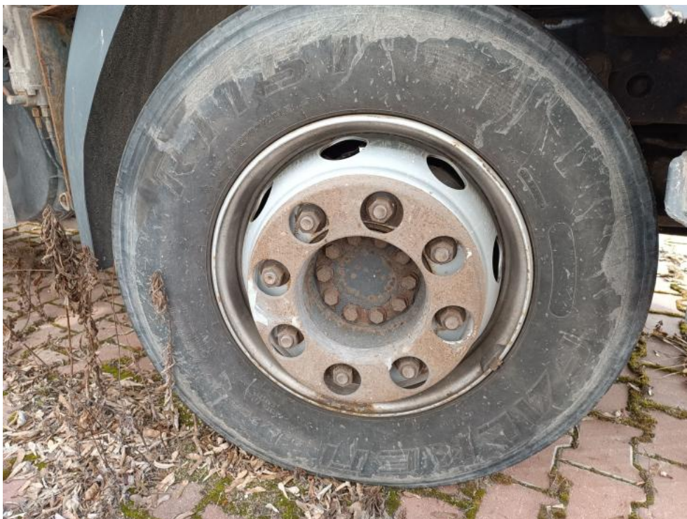
Fot. 88. Felga osi I stal. P - korozja 1
