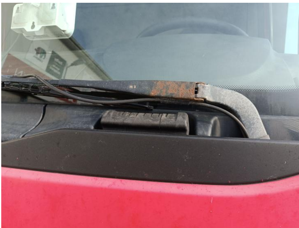
Fot. 43. ramię wycieraczki korozja
