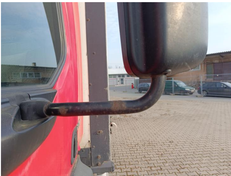
Fot. 42. ramię lusterka korozja
