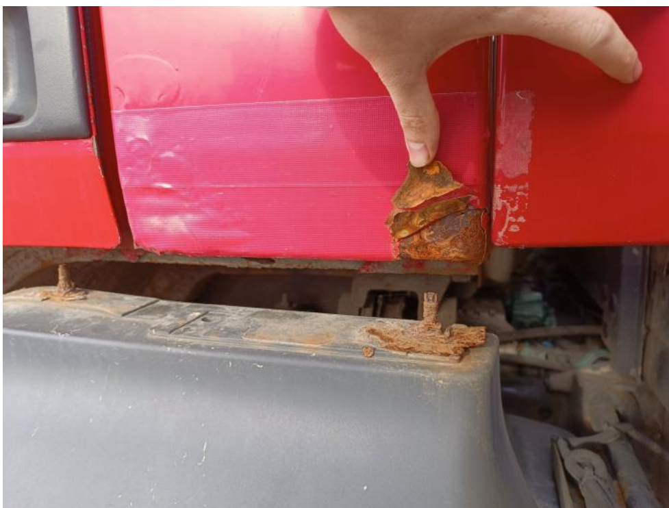
Fot. 38. strona lewa kabiny korozja
