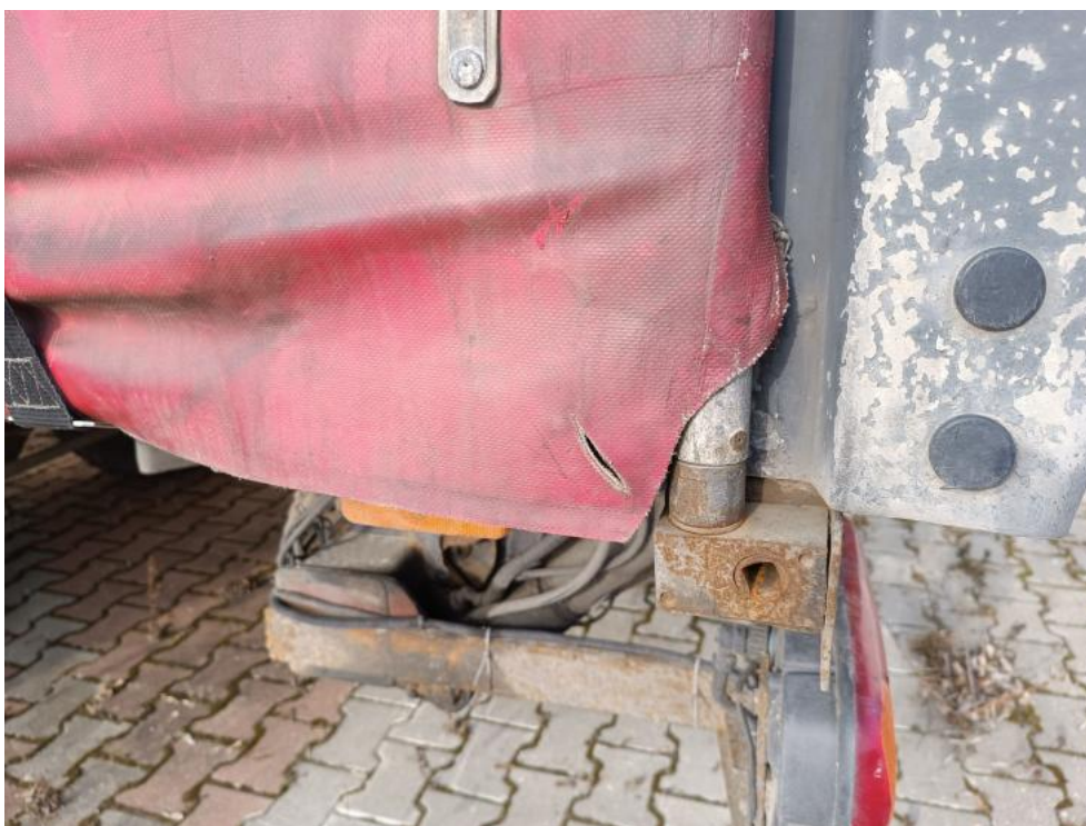
Fot. 53. plandeka rozerwanie lewa strona przy windzie
