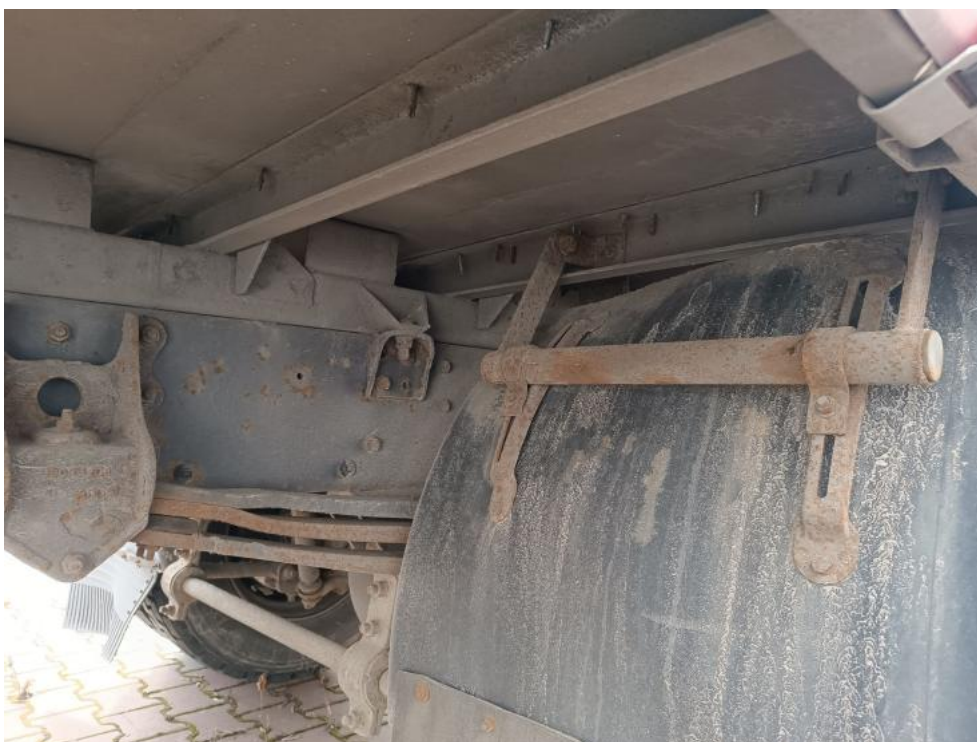
Fot. 48. uchwyt błotnika tył korozja
