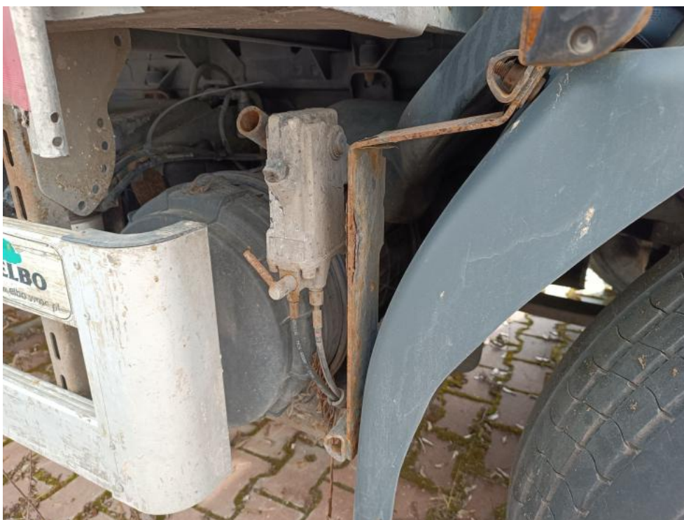
Fot. 47. wspornik za kabiną korozja
