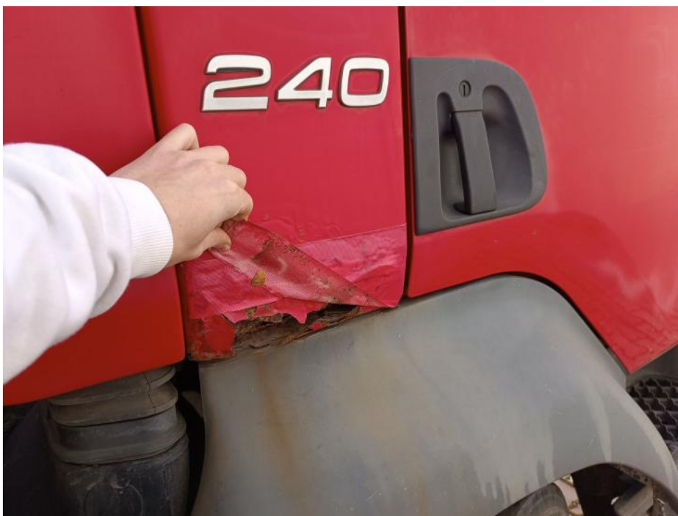
Fot. 37. strona prawa kabiny korozja
