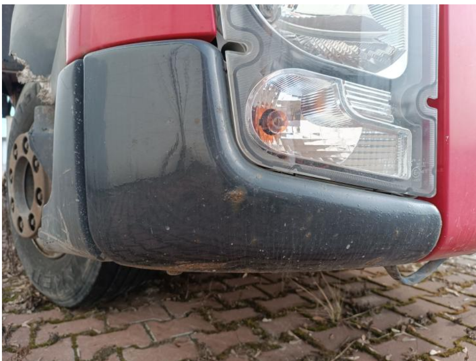
Fot. 44. narożnik zderzaka przód prawy korozja
