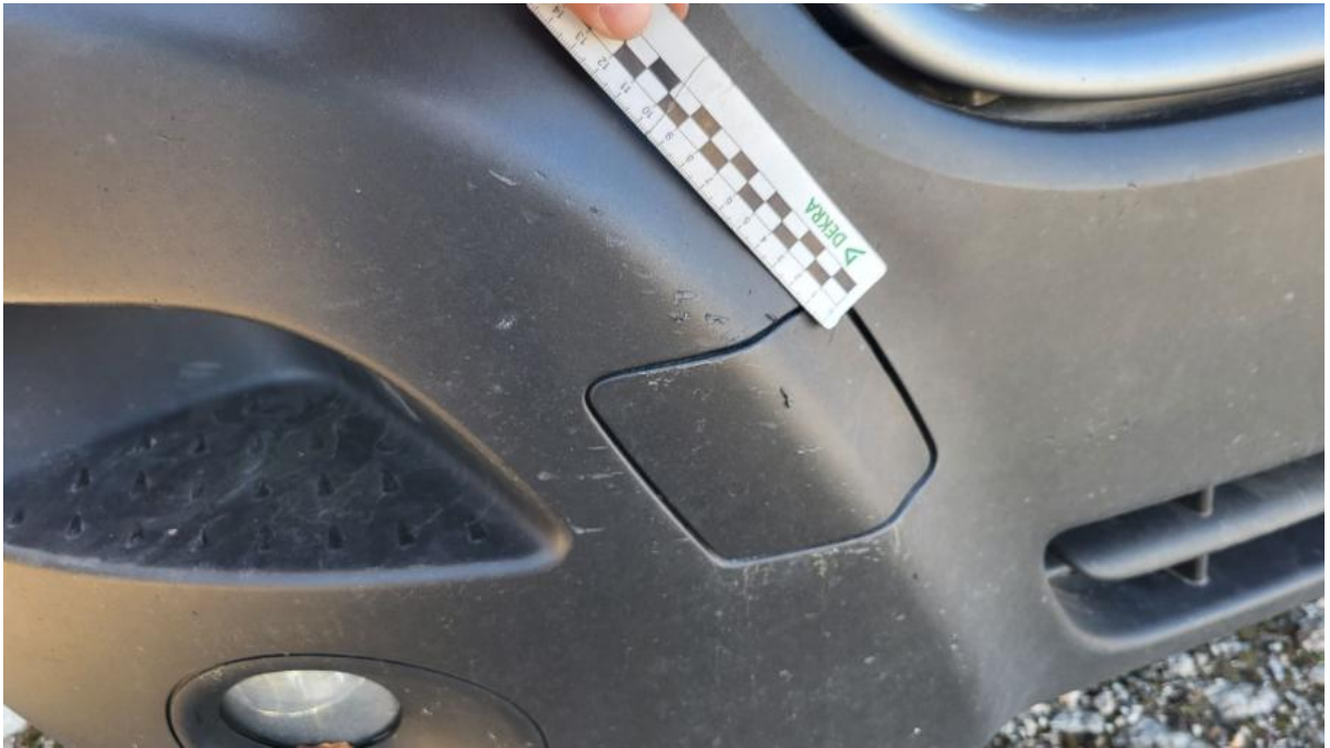
Fot. 39 Zderzak - Rysa/odprysk 1
