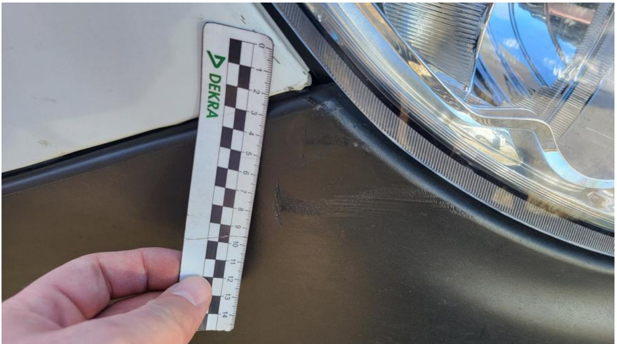
Fot. 40 Zderzak - Wgniecenie/odkształcenie 1
