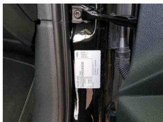
Fahrzeug - Typenschild/Fahrgestellnummer
