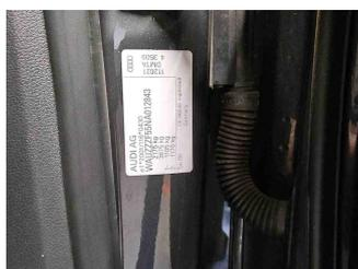
Fahrzeug - Typenschild/Fahrgestellnummer
