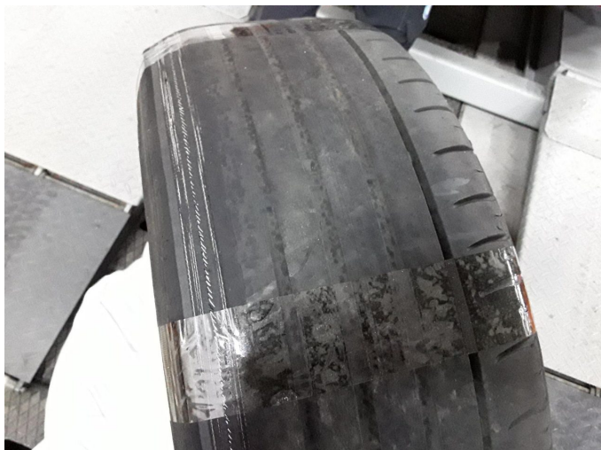
Beschädigung 2: 2.Radsatz: 2 Reifen - verschlissen - erneuern
