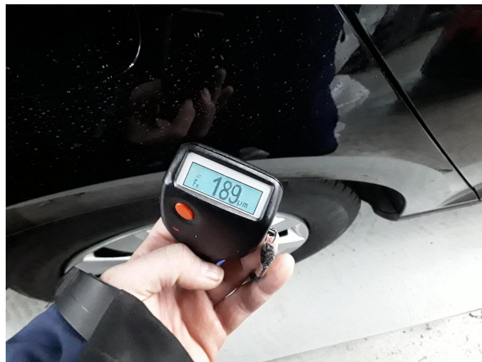
Nachlackierung 1: Seitenwand rechts
